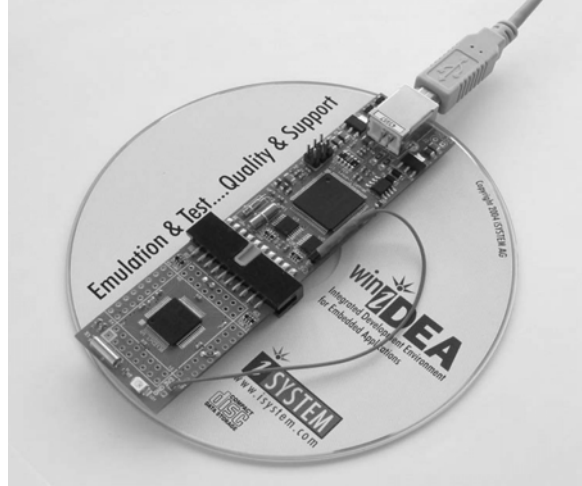
Şekil 14. LPC2138 mikrokontrolör emülatörü
