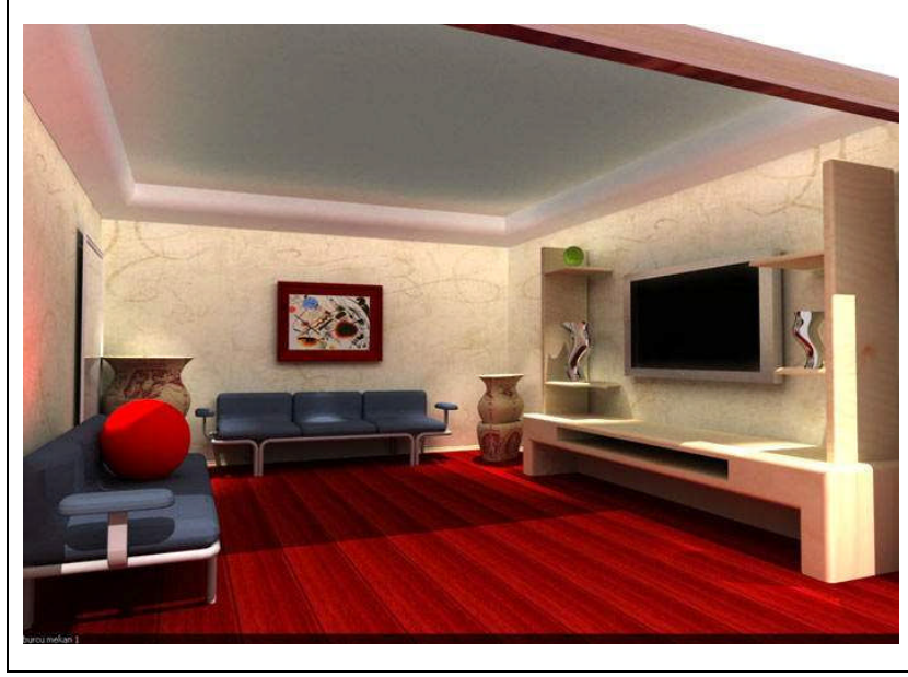
Şekil 22. Yaşama mekanlarında yarı dolaylı aydınlatma örneği
