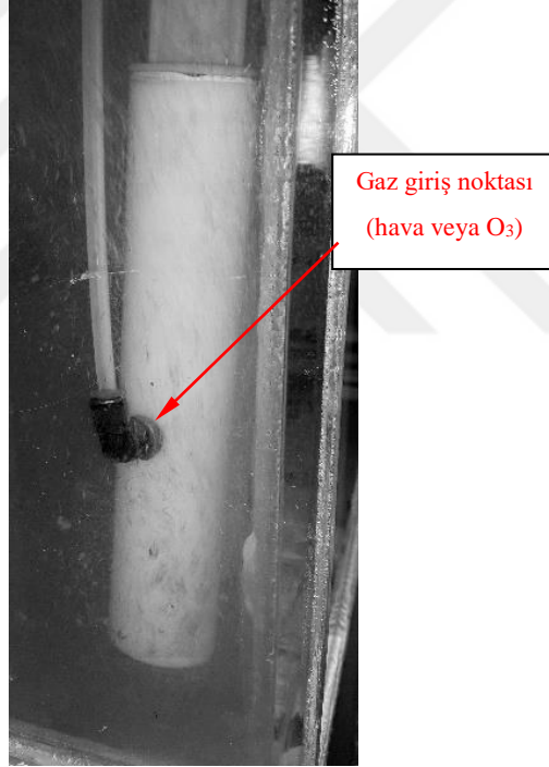
Şekil 3.8. Kavitasyon tüpü üzerindeki gaz giriş noktası
