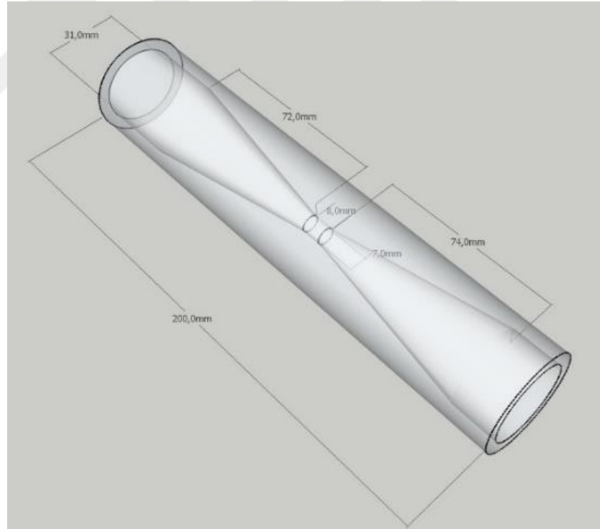
Şekil 3.6. 7,00 mm çapındaki kavitasyon tüpünün üç boyutlu çizimi
