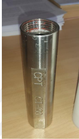
Şekil 3.2. Hazır alınan 5 mm’lik kavitasyon tüpünün fotoğrafı
