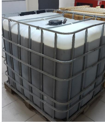
Şekil 3.1. Süngerîç katı atık deponi alanından alınan ve laboratuvara getirilen sızıntı suyu
