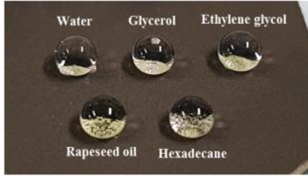
Şekil 2.6. İşlenmiş titanyum yüzeyinde farklı yüzey gerilimli sıvı damlacıkların optik görüntüleri (Lee and Hwang 2017)
