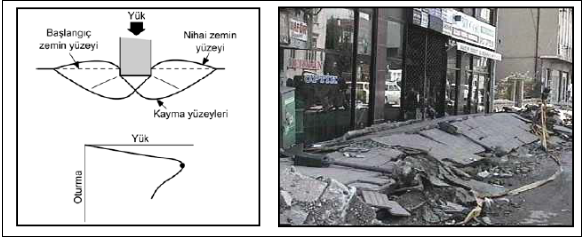
Şekil 1.4. Genel kayma göçmesi (Çinicioğlu, 2003).
