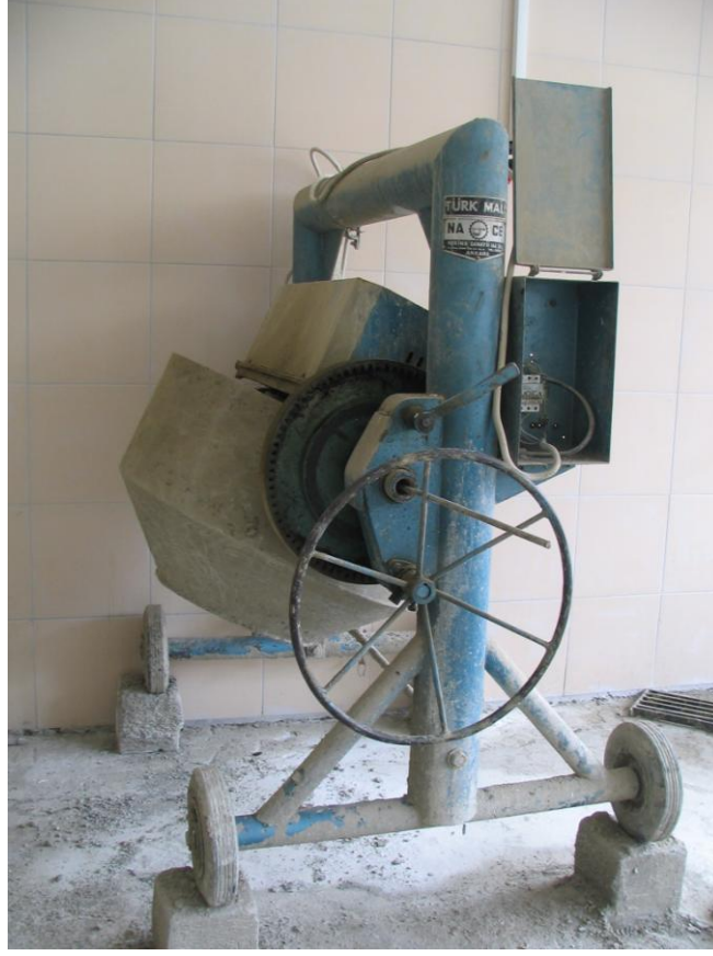
Şekil 40. Eğik eksenli betoniyer
