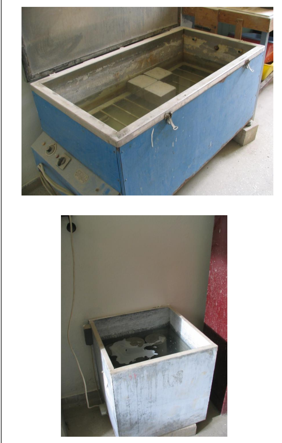
Şekil 44. Standart kür uygulamasının yapıldığı tanklar
