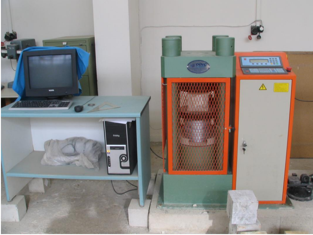
Şekil 45. Beton küp numunelerin merkezi basınç deneyi
