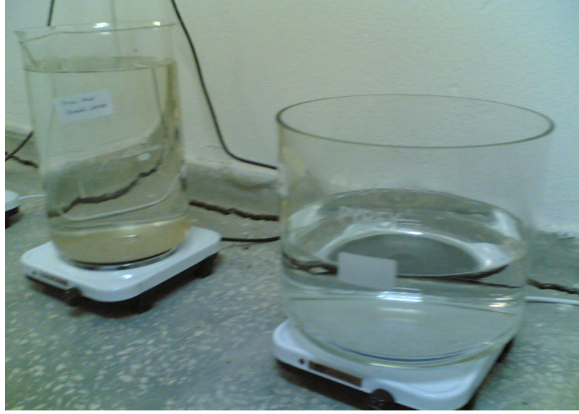
Şekil 2.4. Gama Spektroskopisi sayımları için numunelerin buharlaştırılması
