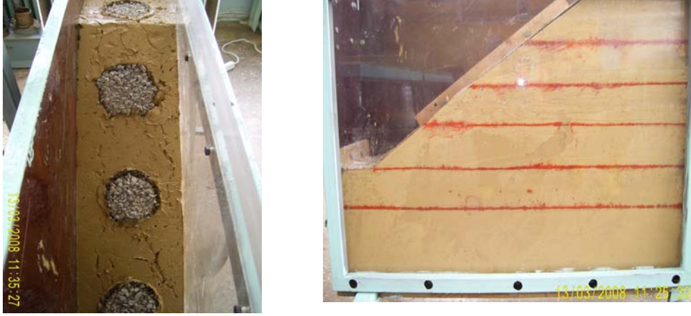
Şekil 2.17. s/D = 2 için şevin oluşturulması
