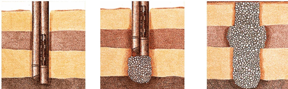
Şekil 1.5. Vibro-öteleme metodu ile taş kolonların imalatı (URL-3, 2008).
