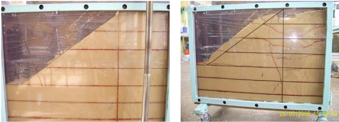
Şekil 2.22. s/D = 3 için deney öncesi ve sonrası şevin durumu
