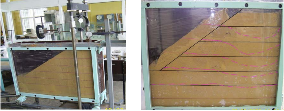
Şekil 2.28. s/D = 4 için deney öncesi ve sonrası şevin durumu
