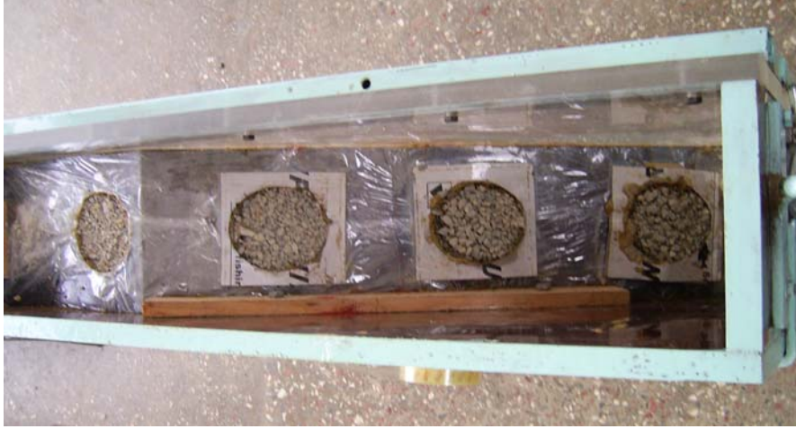
Şekil 2.12. Taş kolonların oluşturulması
