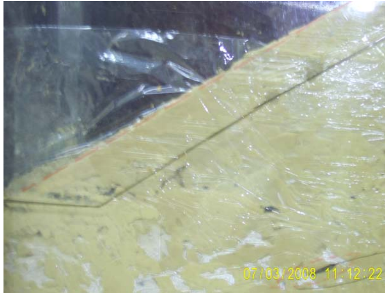
Şekil 2.15. Taş kolonsuz hal için deney sonrası şevin durumu
