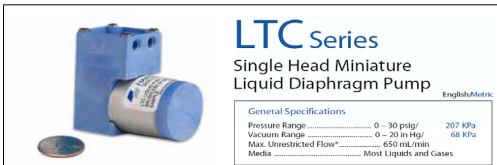
Şekil 2.22. Kullanılan pompa ve teknik özellikler
