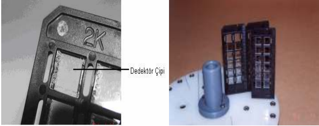
Şekil 20. Dedektör çipi ve kazıma diski
