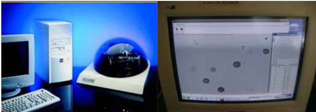
Şekil 21. Radosys ölçüm sistemi ve alfa izlerinin görüntüsü
