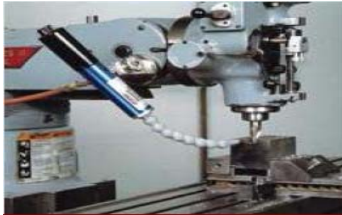
Şekil 3. Frezeleme işleminde spot soğutma olarak (URL-2, 2008)
