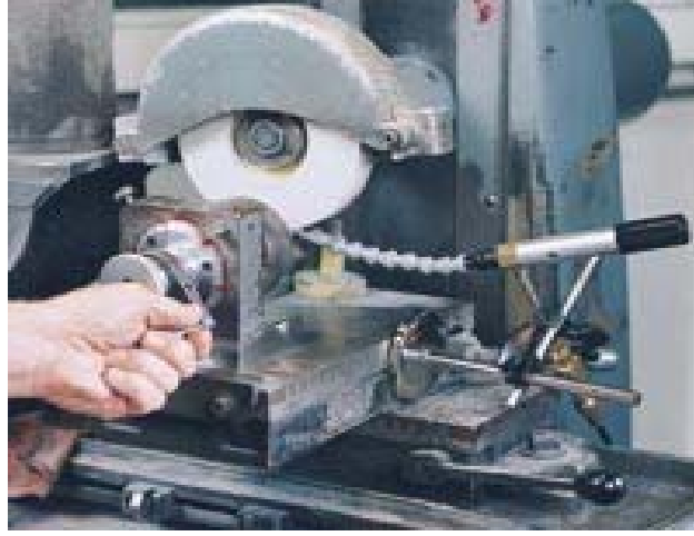
Şekil 4. Taşlama işleminde spot soğutma olarak (URL-2, 2008)
