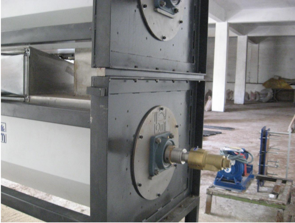
Şekil 21. Döner başlıklı bağlantı elemanı
