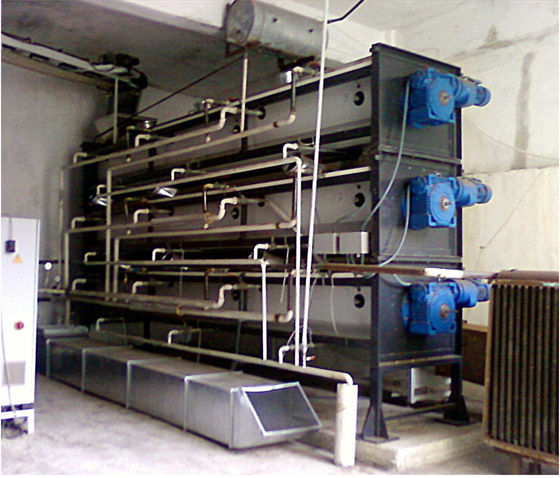
Şekil 19. Helezon çay kurutma makinesi
