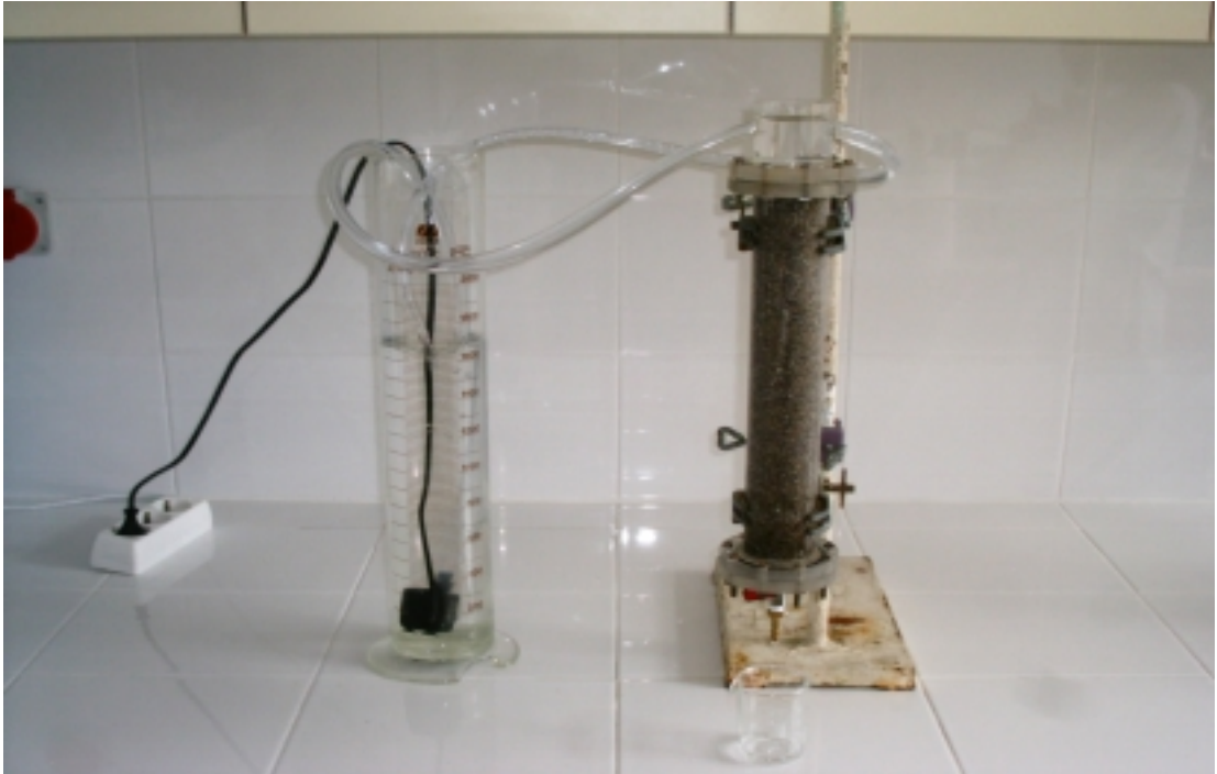
Şekil 4.1. Kolon reaktörün genel yapısı
