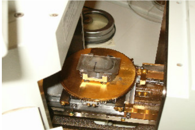
Şekil 1.9. Kesit ile kesit tutucu arasında gümüş sürülerek analiz için mikroprop cihazına konulduğu yuva.
