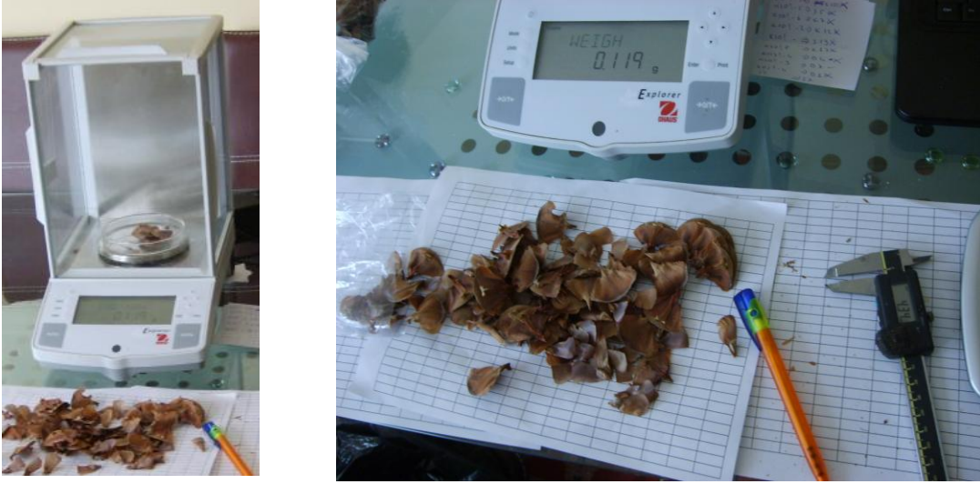
Şekil 7. Ağırlık ölçümlerinin yapıldığı dijital terazi
