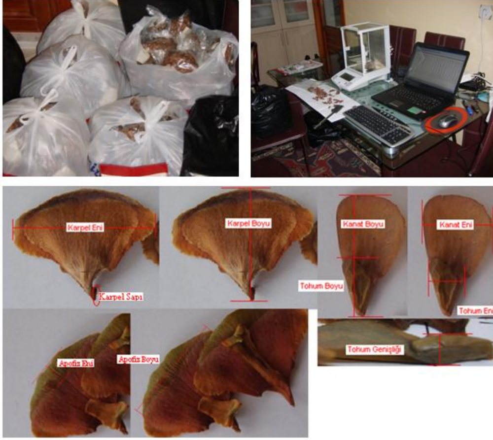
Şekil 6. Ölçümlerin yapıldıkları ortam ve boyutların ölçüldükleri noktalar
