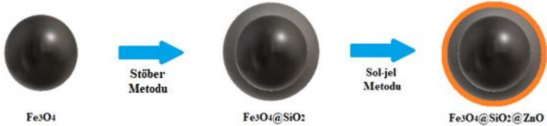
Şekil 3.6. \text{Fe}_3\text{O}_4@\text{SiO}_2@\text{ZnO} sentezinin şematik gösterimi
