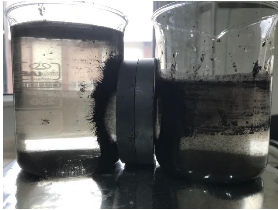
Şekil 3.2. Sentezlenen Fe 3 O 4 'lerin çözelti ortamından ayrılması
