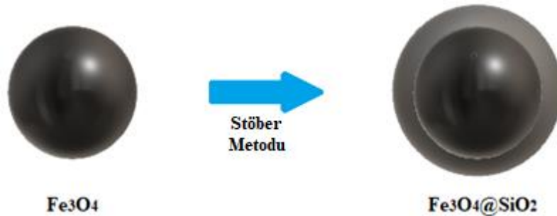
Şekil 3.4. Fe 3 O 4 @SiO 2 sentezinin şematik gösterimi
