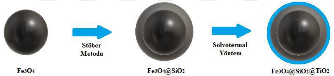
Şekil 3.5. Fe 3 O 4 @SiO 2 @TiO 2 sentezinin şematik gösterimi
