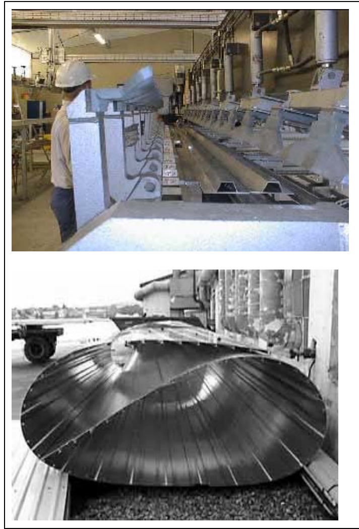
Şekil 5. Yüksek hız feribotlarında kullanılan alüminyum ekstrüzyon panellerinin sürtünme karıştırma kaynağı ile birleştirilmesi [13].
