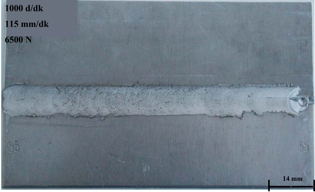
Şekil 50. 1000 d/dk dönme hızında 115 mm/dk ilerleme hızında 6500 N yük altında yapılan deneyden elde edilen numune
