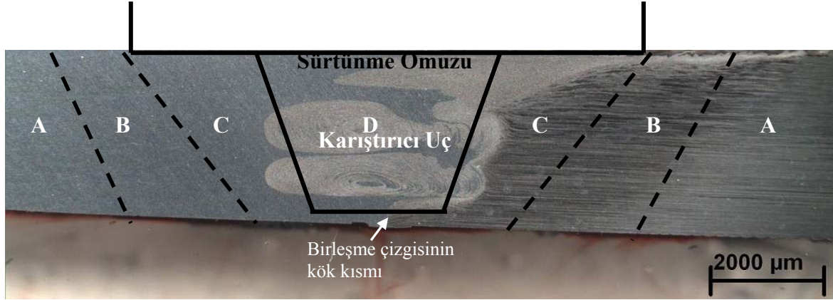
Şekil 59. Mikrosertlik ölçümlerine göre kaynaklı bölge mikroyapısı
