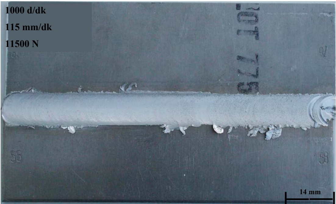
Şekil 53. 1000 d/dk dönme hızında 115 mm/dk ilerleme hızında 11500 N yük altında yapılan deneyden elde edilen numune
