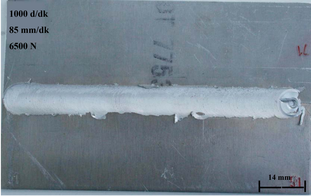
Şekil 46. 1000 d/dk dönme hızında 85 mm/dk ilerleme hızında 6500 N yük altında yapılan deneyde elde edilen kaynaklı numune
