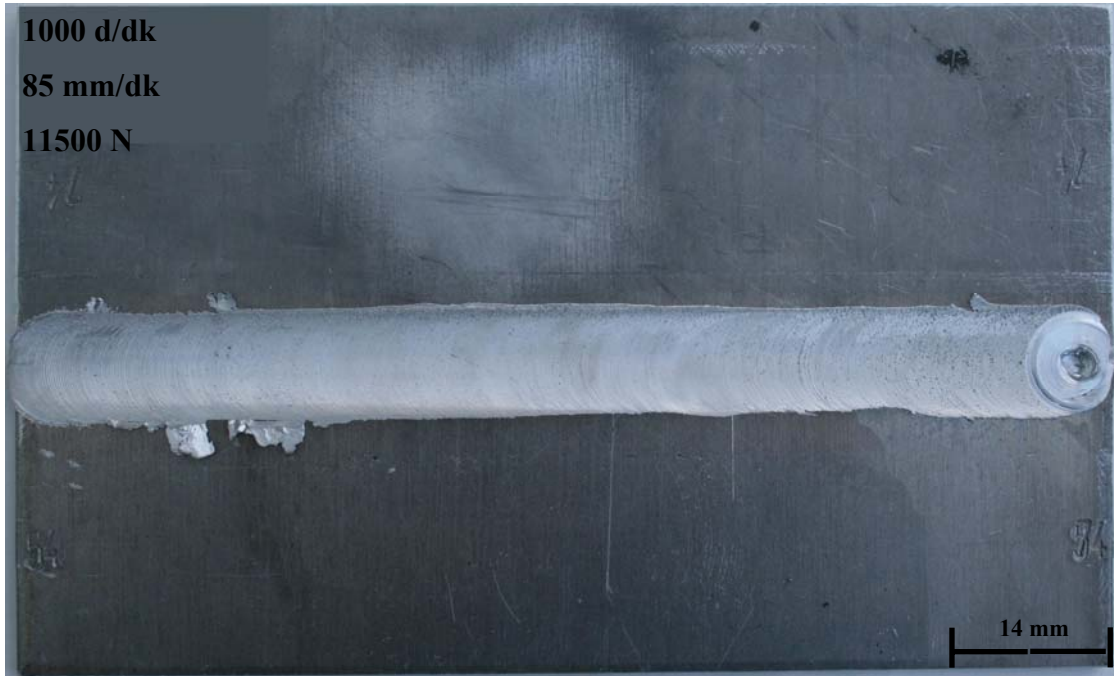
Şekil 49. 1000 d/dk dönme hızında 85 mm/dk ilerleme hızında 11500 N yük altında yapılan deneyde elde edilen kaynaklı numune
