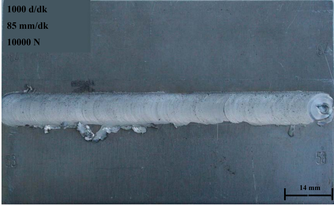
Şekil 48. 1000 d/dk dönme hızında 85 mm/dk ilerleme hızında 10000 N yük altında yapılan deneyde elde edilen kaynaklı numunenin görünümü
