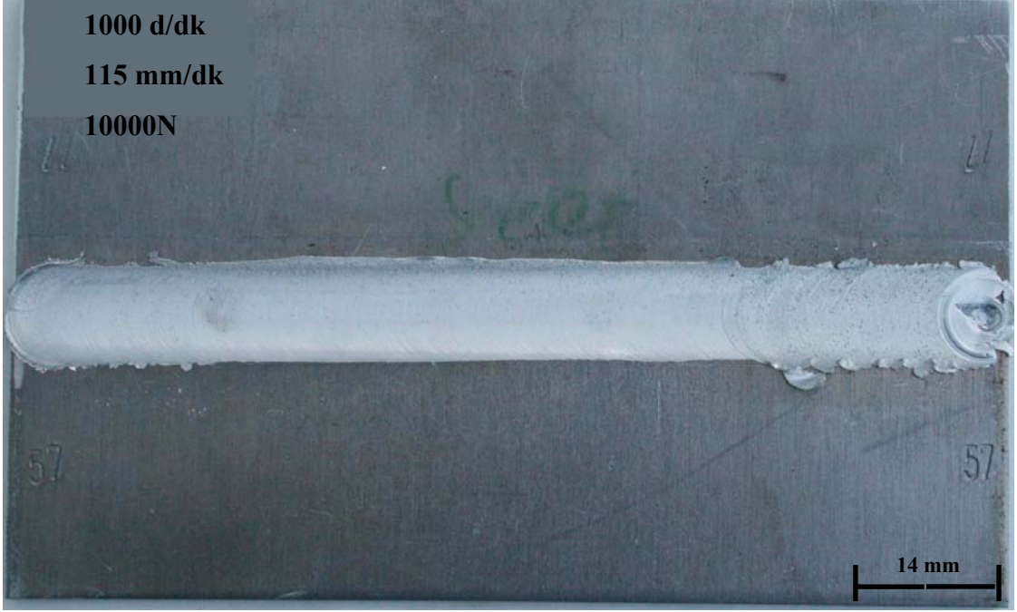
Şekil 52. 1000 d/dk dönme hızında 115 mm/dk ilerleme hızında 10000 N yük altında yapılan deneyden elde edilen numune
