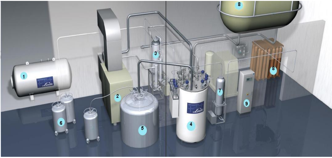
Şekil 3.3 Helyum soğutma sisteminin genel görünümü.
