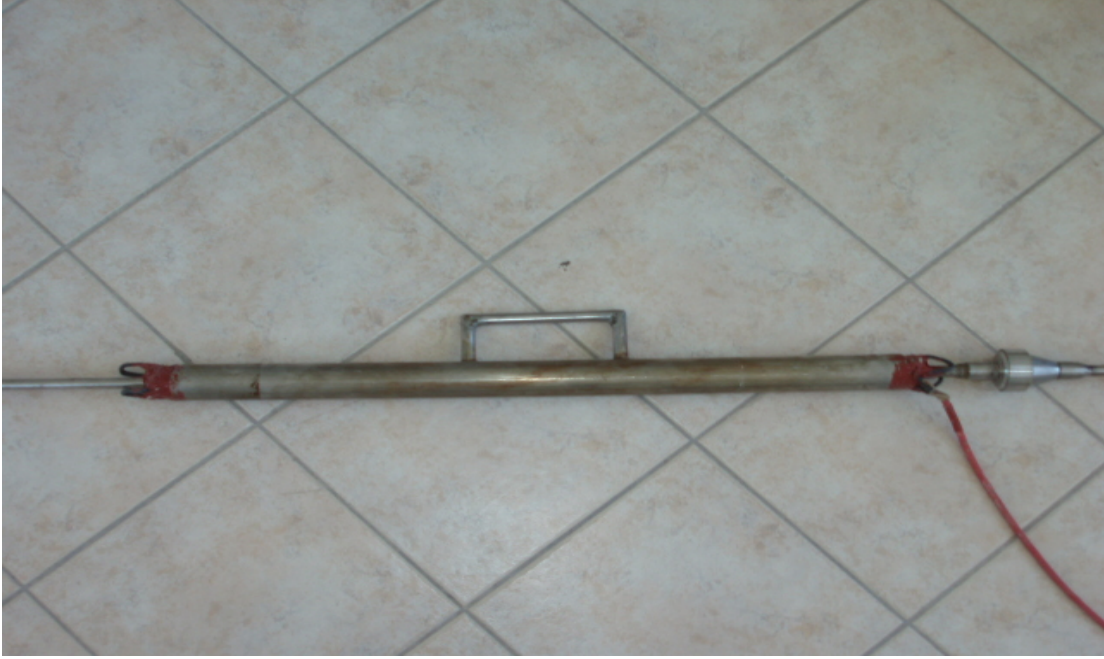
Şekil 2.3. Isıtmalı prob ve filtre kartuşunun fotoğrafı
