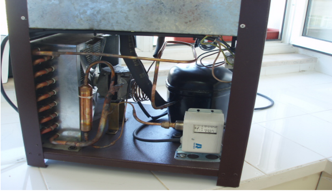
Şekil 2.6. Klasik soğutma sisteminin fotoğrafı
