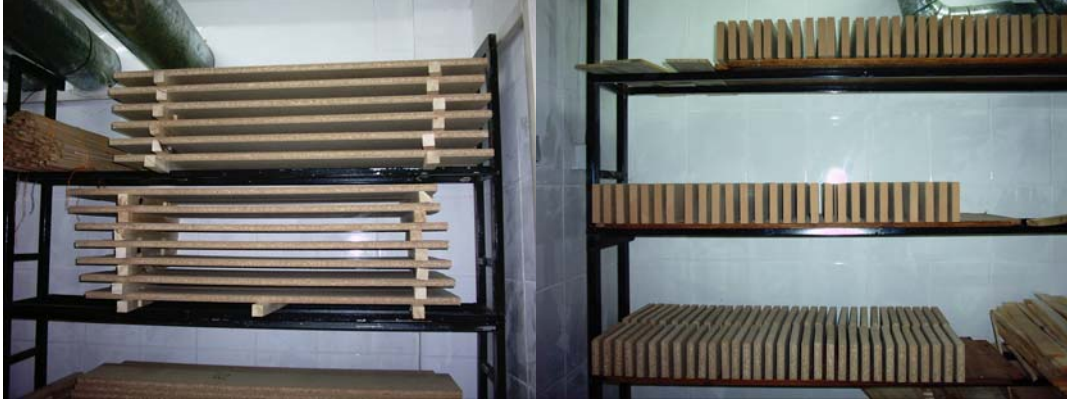
Şekil 3.3. B1 ve B2 yanma deneyleri için numunelerin klima odasına yerleştirilmesi.
