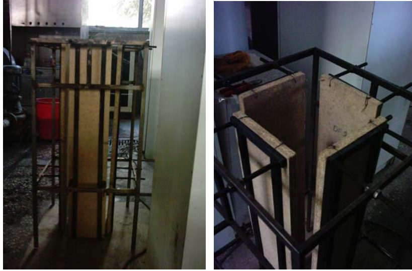
Şekil 3.4. Deney numunelerinin düzeneğe bağlanması.
