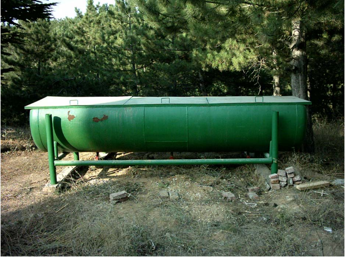
Şekil 3.1. Daldırma metodunda kullanılan emprenye havuzu
