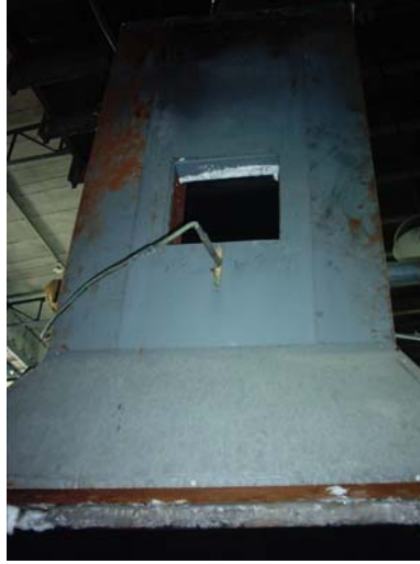
Şekil 3.5. Baca sıcaklığını ölçmek için kullanılan termometre
