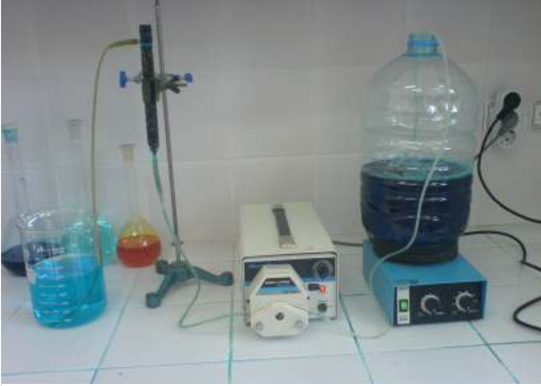
Şekil 4.1. Sürekli düzende çalışan dolgulu kolon reaktör
