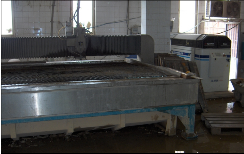
Şekil 6.13. Aşındırıcılı su demeti kesme makinesinin genel görünümü
