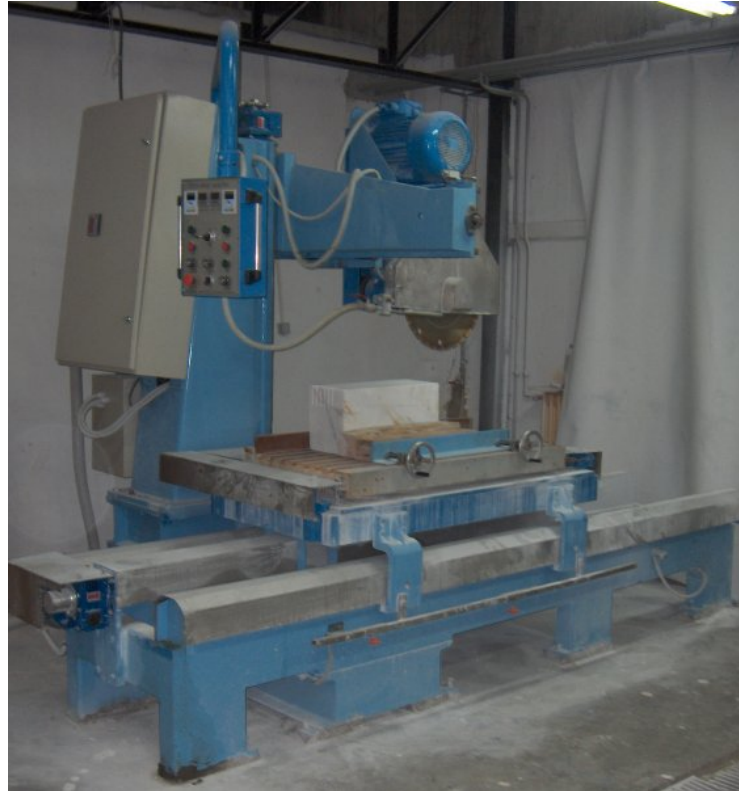
Şekil 9.5. Bilgisayar kontrollü dairesel testereli yan kesme makinesi
