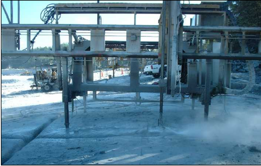
Şekil 5.4. Granit ocağında kullanılan su demetli kesme makinesi (Ferris and Hall, 2004)
