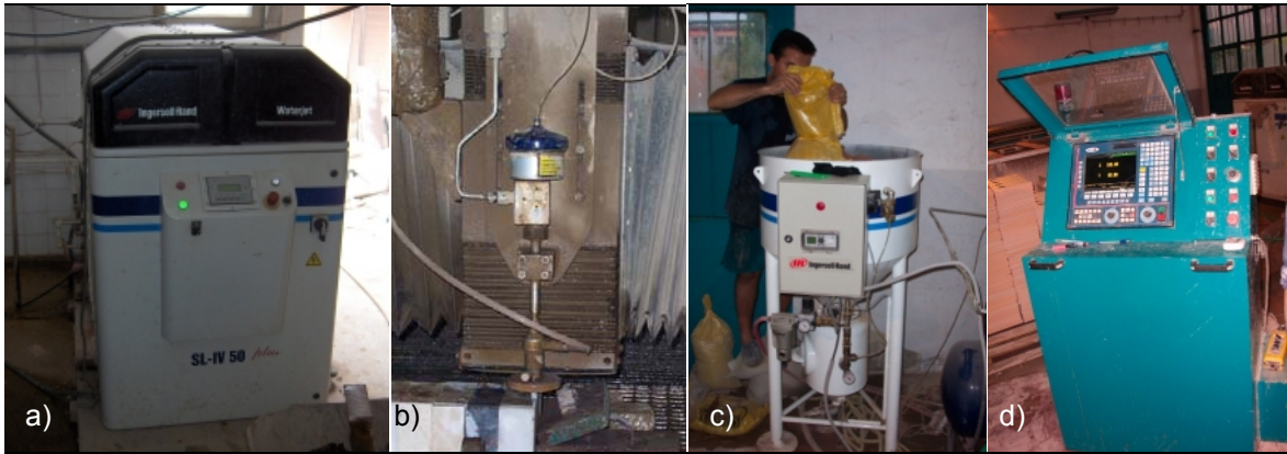
Şekil 6.14. Aşındırıcılı su demeti kesme makinesinin temel bileşenleri (a: yüksek basınç pompası, b: aşındırıcılı su demeti birimi, c: aşındırıcı besleme birimi, d: kontrol birimi)
