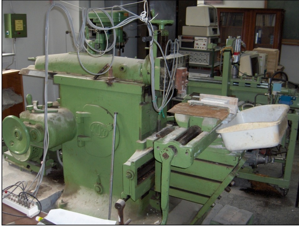
Şekil 9.1. Küçük boyutlu kazı deney seti
