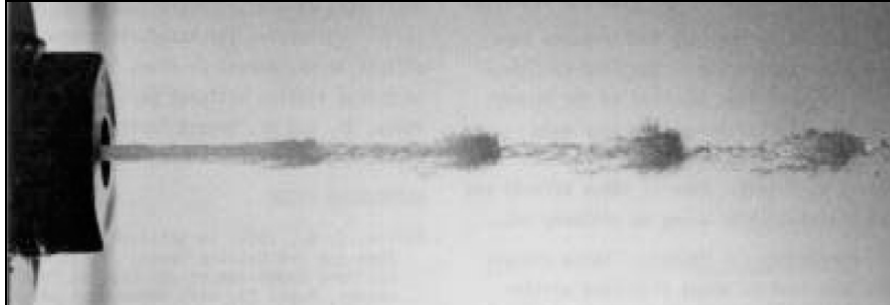
Şekil 4.1. Kesikli su demetinin hızlı çekim fotoğraf görüntüsü (Nebeker, 1983)
