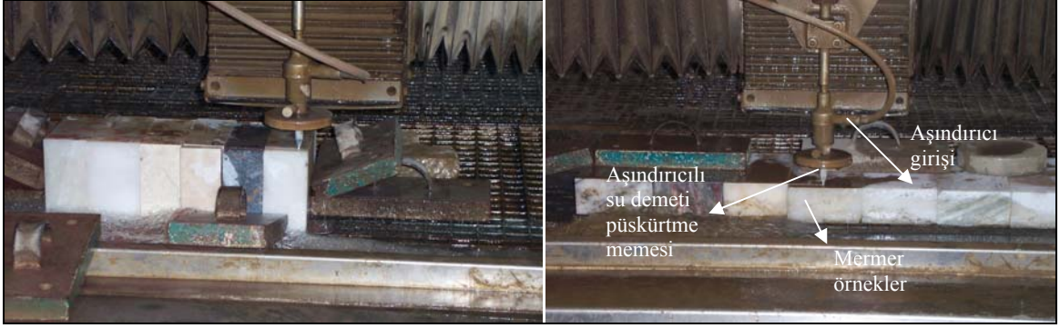
Şekil 6.16. Doğal taş örneklerinin aşındırıcı su demetiyle kesimi sırasındaki görüntüler
