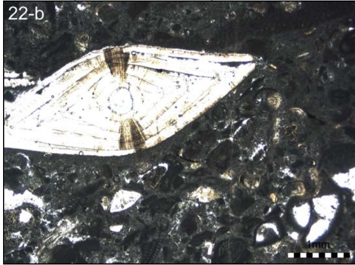
Şekil 6.9. Sparitleşmiş fosilli kireçtaşı örneğinin (Fosilli Bej) örneğinin ince kesit fotoğrafı (Objektif: x 2,5)
