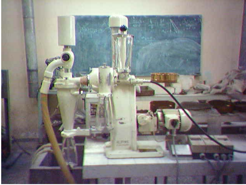
Şekil 4.3. Laboratuvar tipi 3. nesil yüksek verimli separatör
