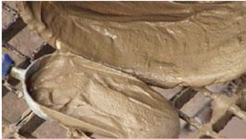
Şekil 2. Macun dolgunun yapısal görünümü
