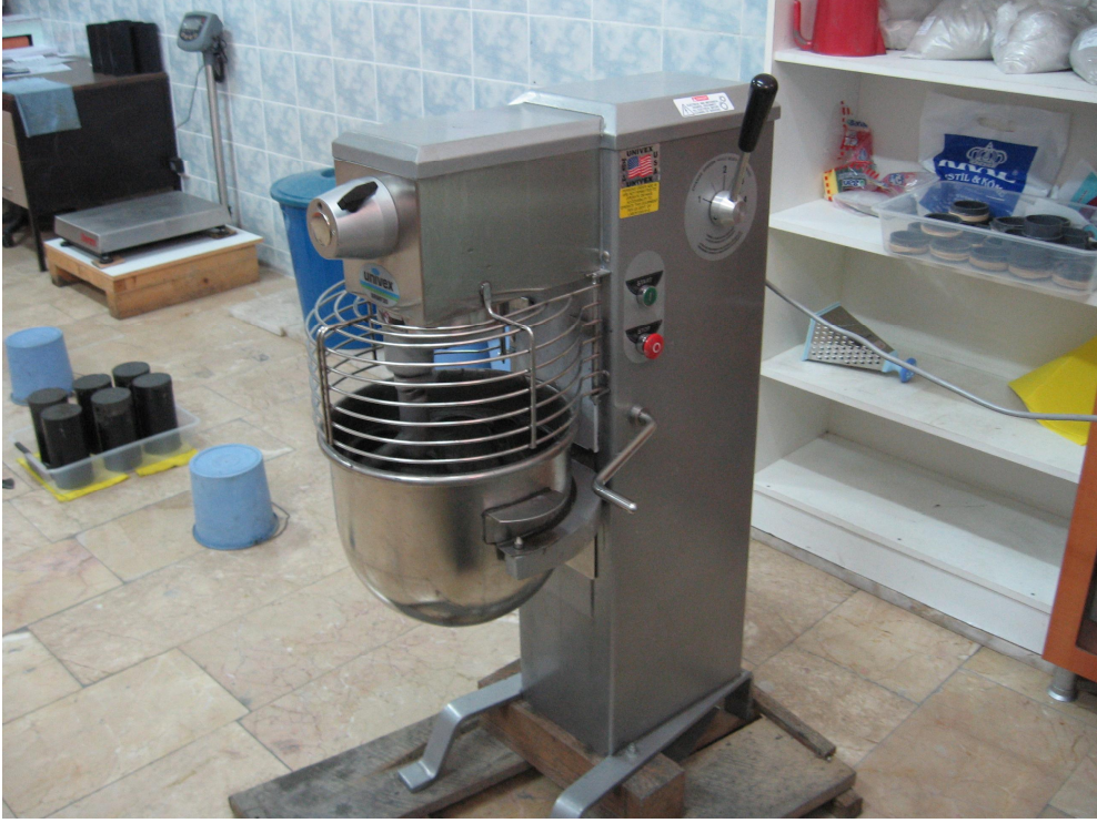
Şekil 24. Macun dolgu hazırlanmasında kullanılan mikser
