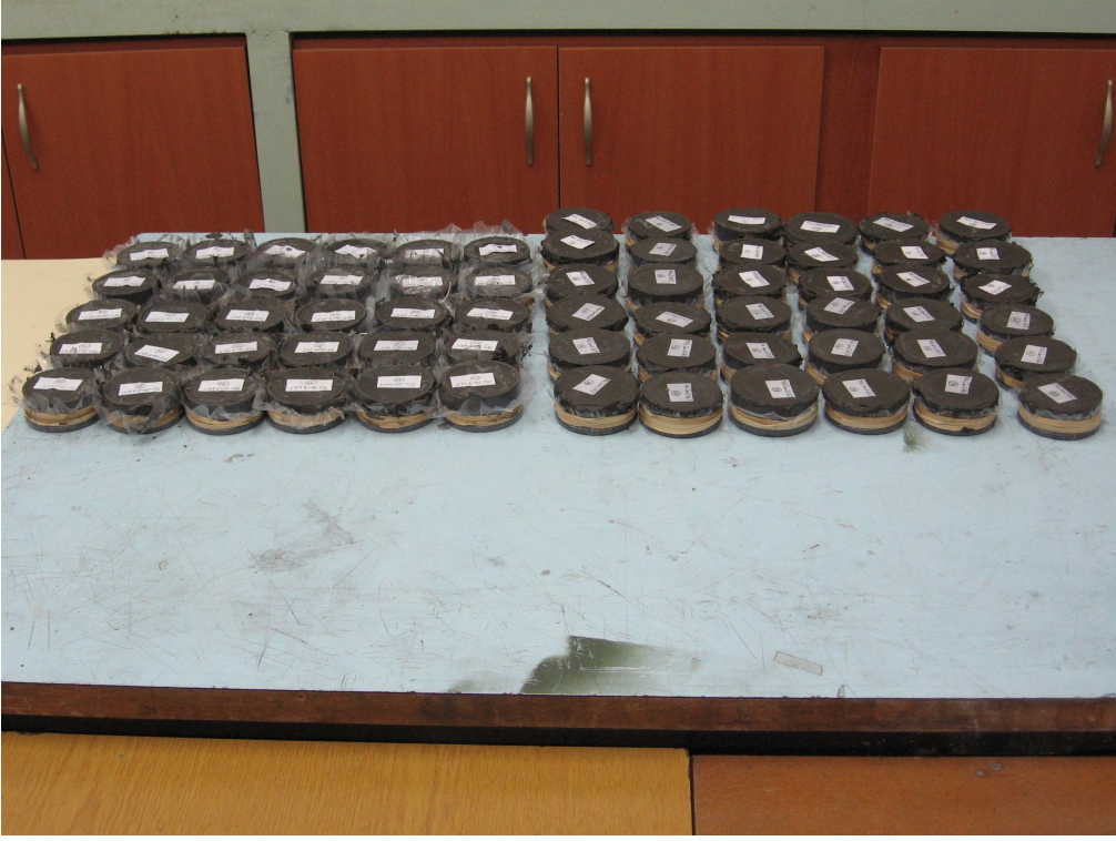
Şekil 25. Kesme dayanım deneyi için hazırlanan numuneler
