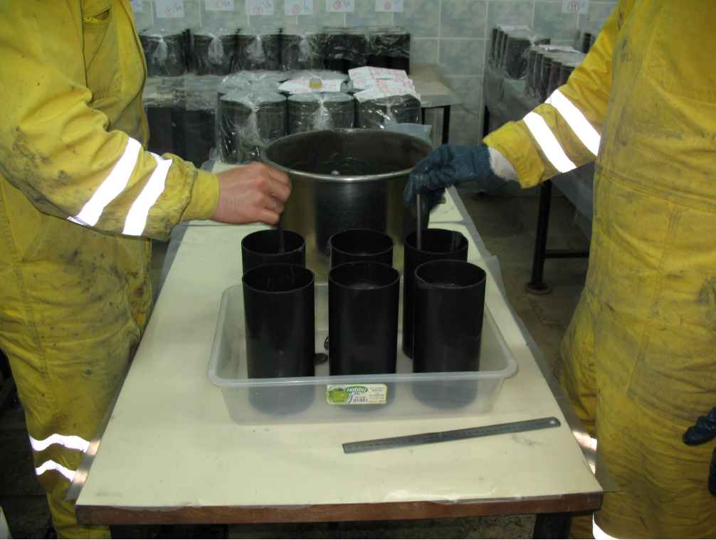
Şekil 26. Tek eksenli basınç dayanım deneyi için hazırlanan numuneler
