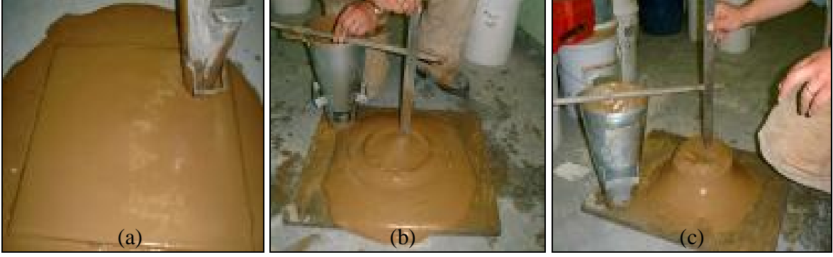
Şekil 9. Slump değeri yüksek (a), normal (b) ve düşük (c) dolgu
