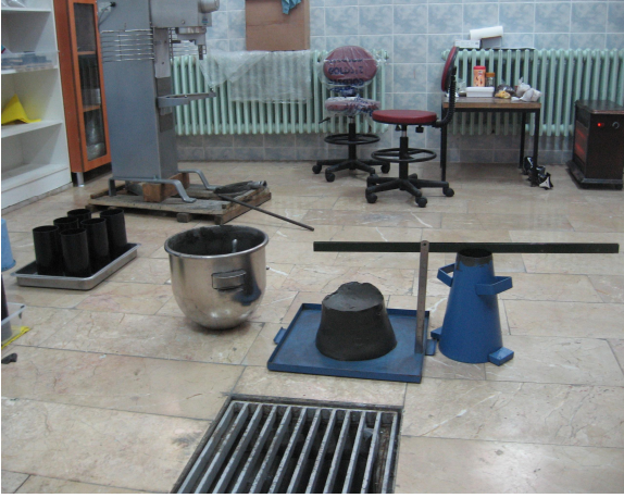
Şekil 22. Slump ölçüm işlemi
