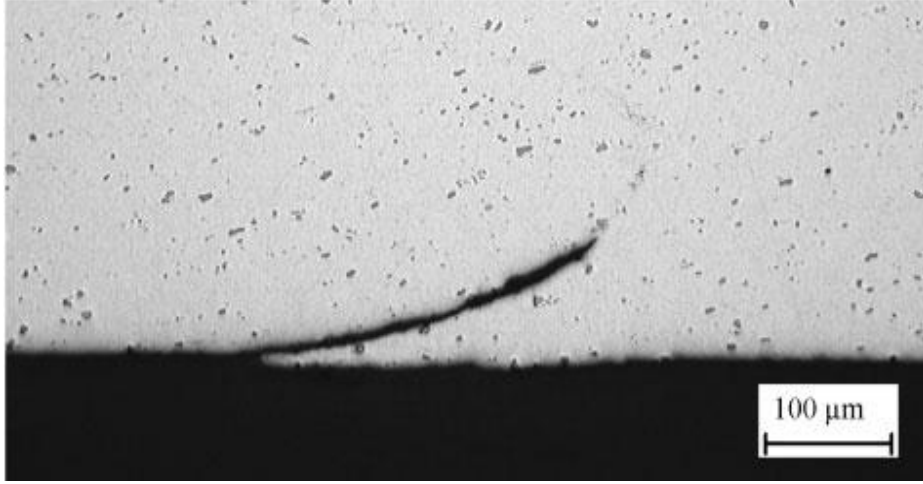
Şekil 1.6. AA5083 alaşımında oluşan kök boşluğu [17].
