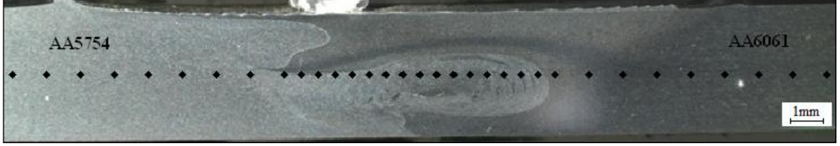
Şekil 3.11. Kaynaklı numunelerin mikrosertlik ölçüm gösterimi
