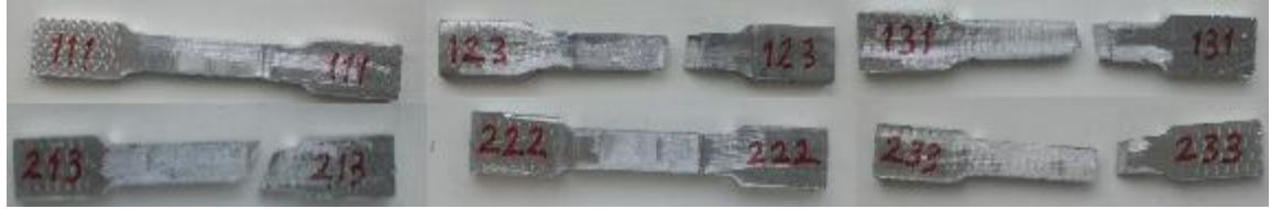
Şekil 3.17. Kaynak boyunca çıkarılan çekme numunelerinin kopma resimleri
