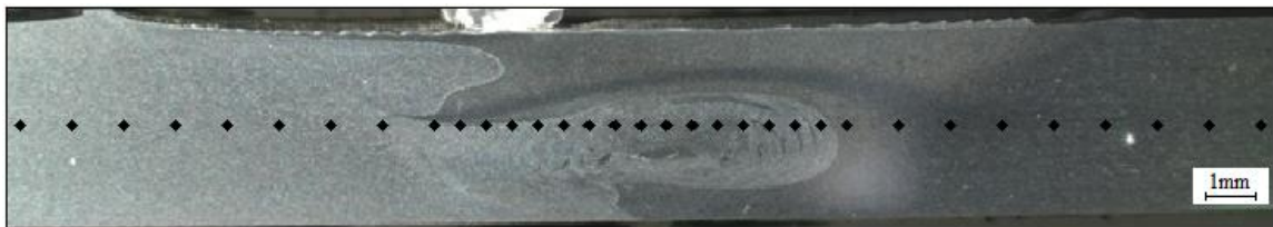
Şekil 2.13. Kaynak bölgesinde sertlik alınan noktaların gösterimi
