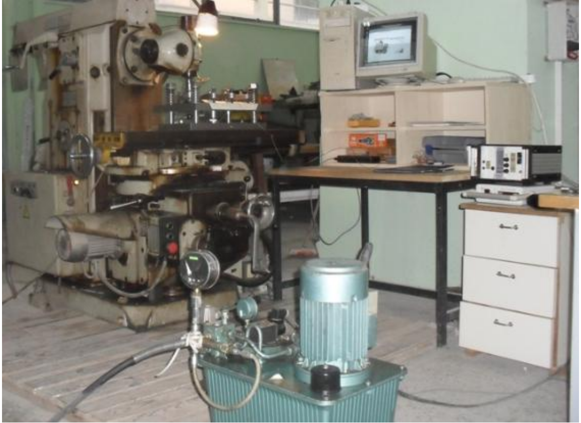
Şekil 2.1. Sürtünme karıştırma kaynak düzeneğinin görüntüsü
