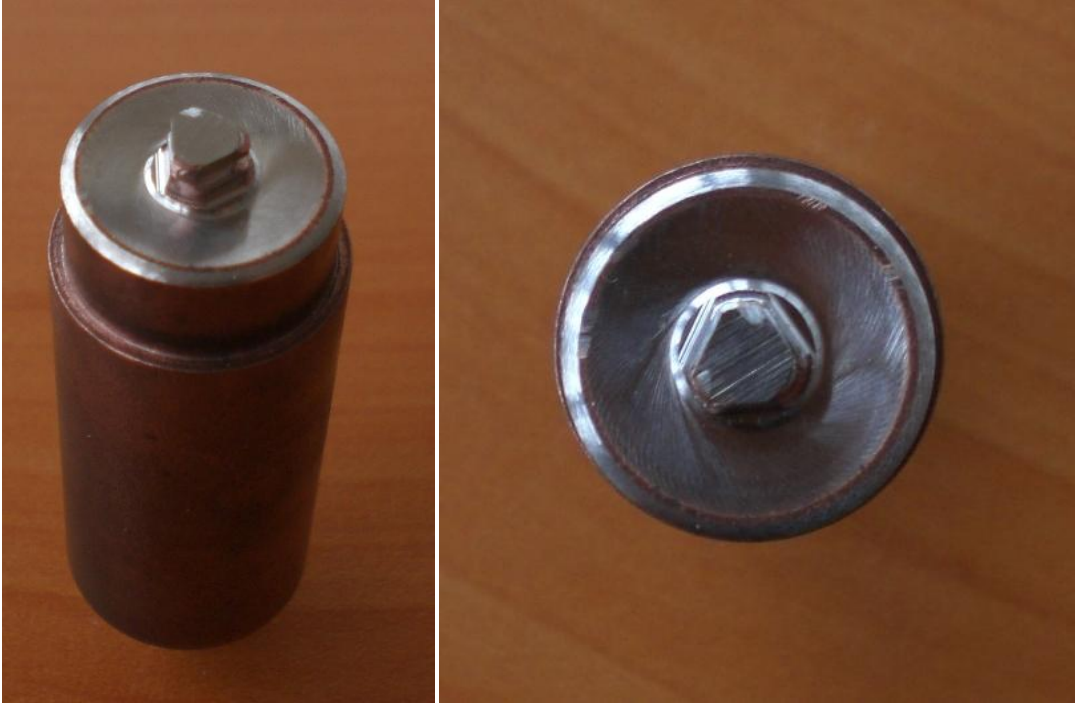
Şekil 2.4. Karıştırıcı takımın yandan ve üstten görünümü
