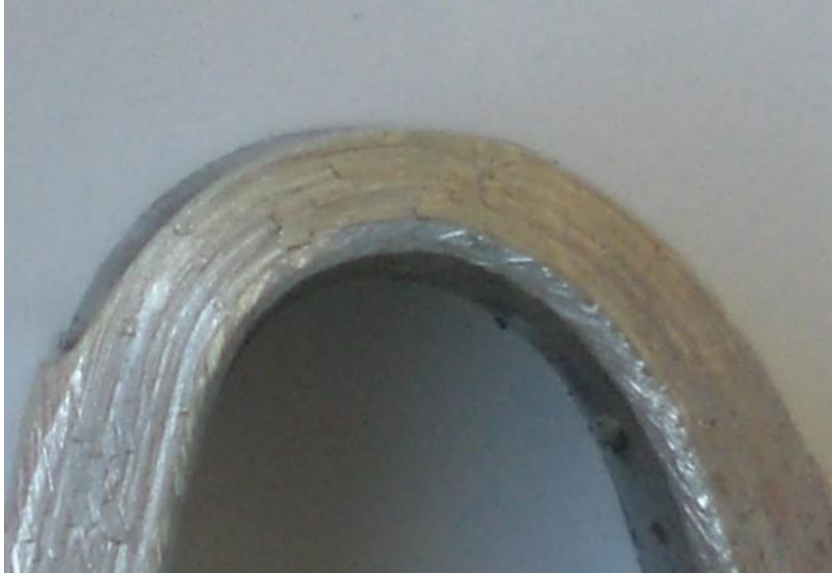
Şekil 3.20. 113 numaralı numunenin eğme deneyi sonrası yan görünümü
