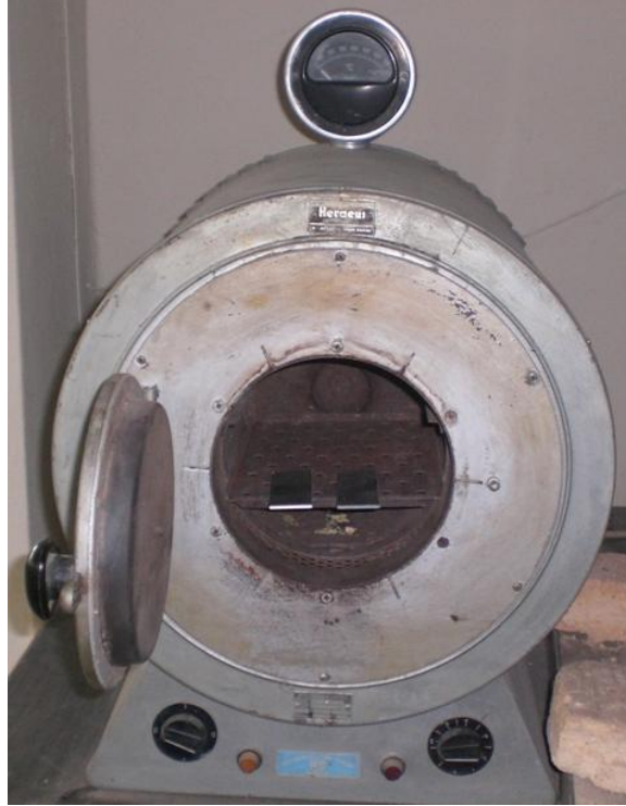
Şekil 3.4. AA5754 ve AA6061 alaşımlarına uygulanan ısıl işlem
