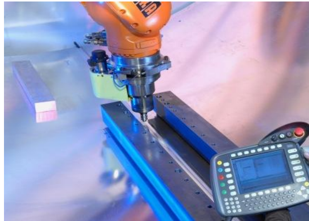
Şekil 1.3. Robotik kola sahip, bilgisayar kontrollü SKK düzeneği [15].
