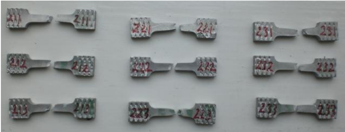
Şekil 3.19. 2xx numaralı numunelere ait çekme deneyi sonrası kopma şekilleri
