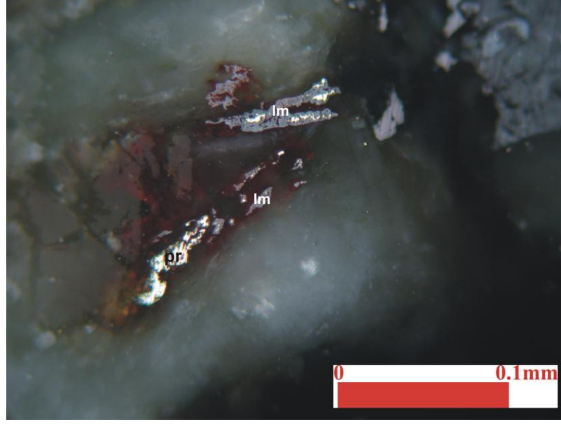
Şekil 6.44 Limonit (lm) içinde pirit (pr) kalıntısı Örnek No: AG-6
