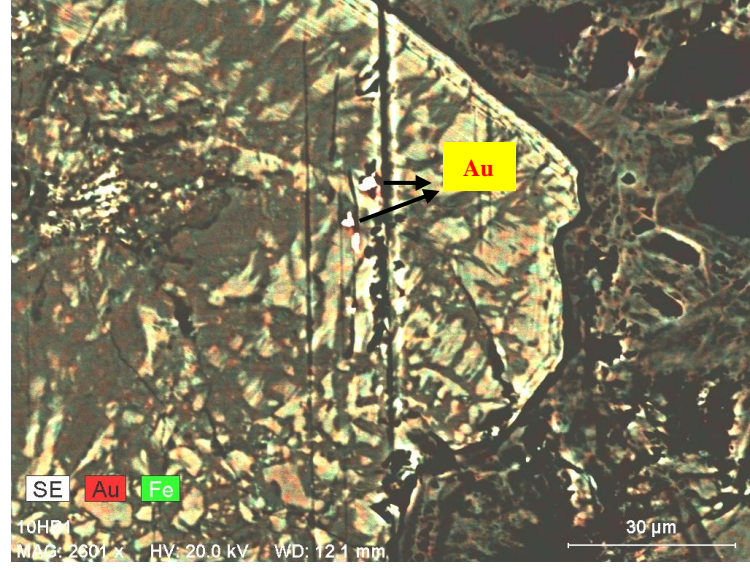
Şekil 6.6 SEM-EDS çalışmalarında belirlenen altın (Au) taneleri Örnek No: 10 HB 1
