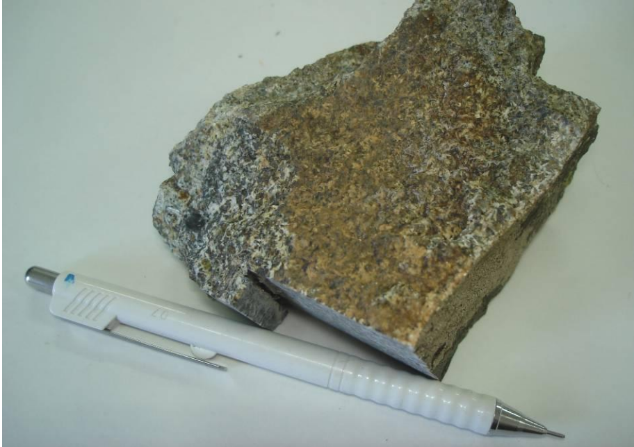
Şekil 5.61 Faneritik dokulu, beyaz plajiyoklaz ve yeşil piroksen mineralleri içeren gabronun el örneği Örnek No: AG-5
