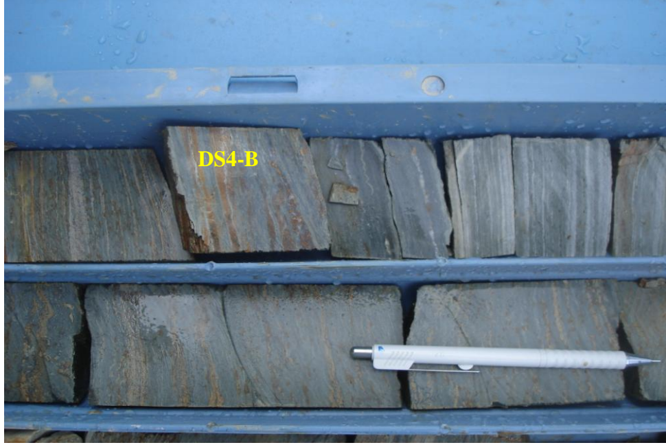
Şekil 9.6 DS4-B sondaj karot örneği Muskovit-kuvars şist ve limonitli seviyeler
