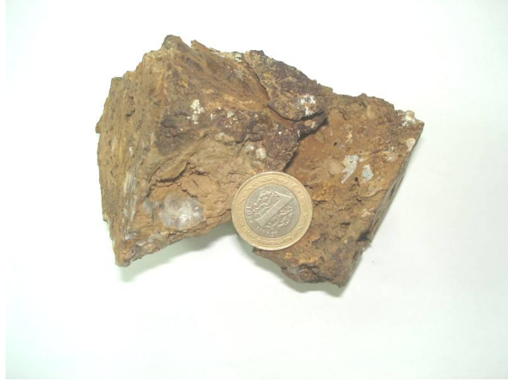
Şekil 5.14 Hematitli cevher damarı içinde boşluk dolgusu biçiminde kuvars kristalleri Örnek No: 10HB-1
