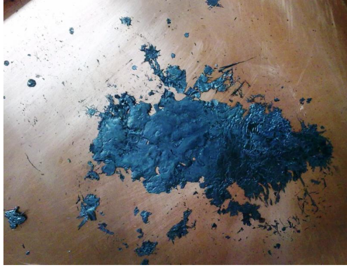
Şekil 2.5. Eritme işleminden sonra bakır plakaya dökülerek hızlı soğuması sağlanan Sm123 toz karışımı
