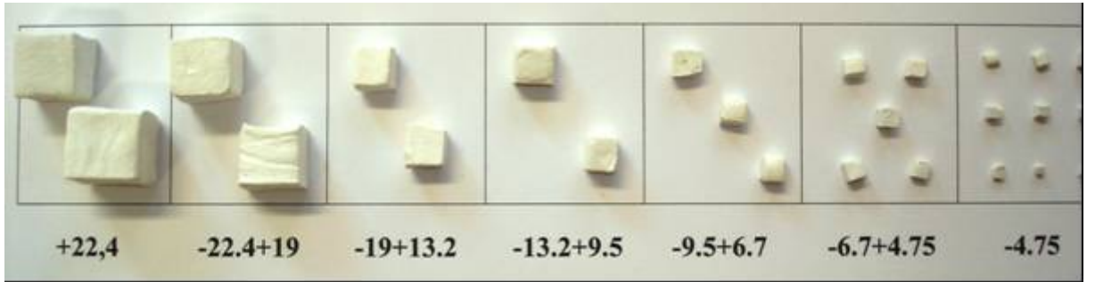
Şekil 3.4. b) Küp şeklinli ve farklı tane boyu aralıklarındaki deney numuneleri
