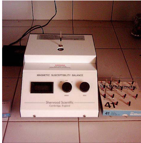
Şekil 3.1. Karışımların manyetik alınganlıklarının ölçümünün yapıldığı MSB Mk 1 manyetik alınganlık ölçer ve ölçüm tüpleri
