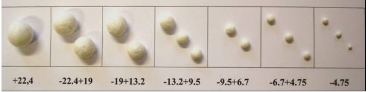
Şekil 3.4. a) Küre şeklinli ve farklı tane boyu aralıklarındaki deney numuneleri
