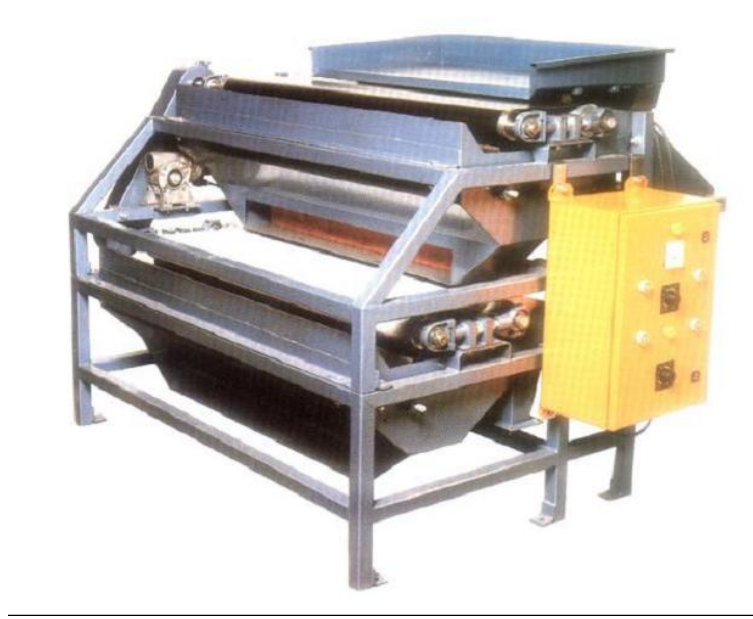
Şekil 2.8. Endüstriyel ölçekli rulo tipi kuru manyetik ayırıcı (Bateman Permroll)
