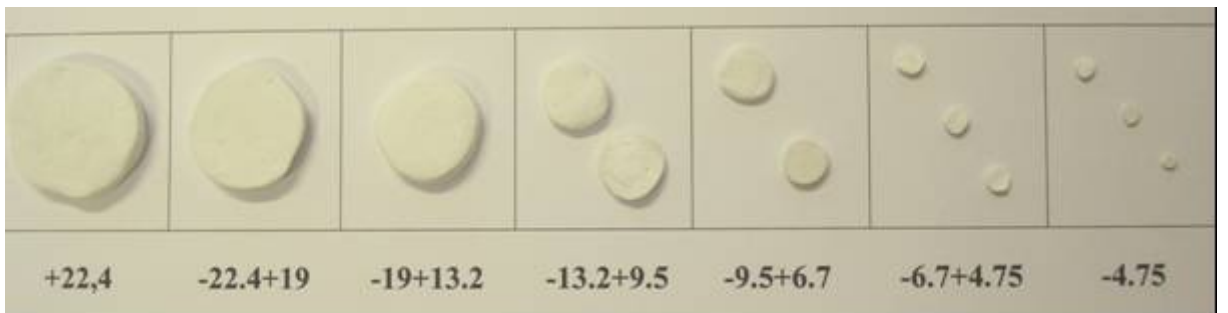
Şekil 3.4. d) Disk şeklinli ve farklı tane boyu aralıklarındaki deney numuneleri
