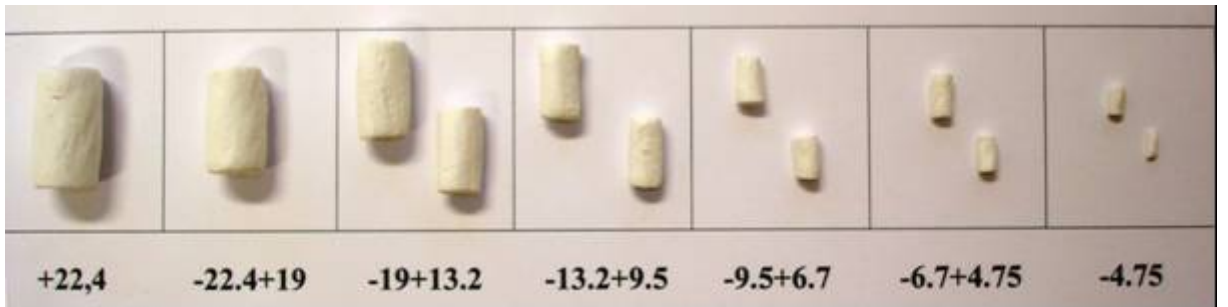
Şekil 3.4. c) Silindirik şeklinli ve farklı tane boyu aralıklarındaki deney numuneleri
