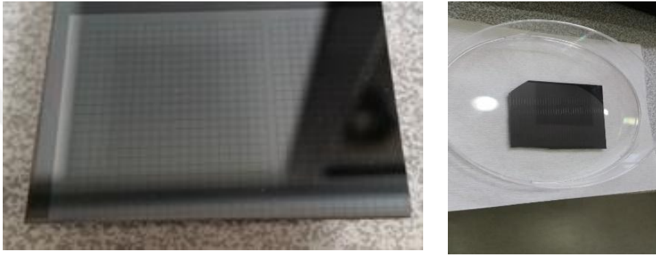
Şekil 4.8. Fotolitografi ile herbiri 50 µm kalınlığında olan ızgara yapısı üzerine aktarılan silikon dilim
