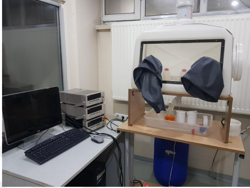
Şekil 3.20. Anodizasyon ve ölçüm düzeneği
