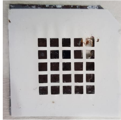
Şekil 4.24. Ön yüzü PVC film ile kaplanan silikon dilim
