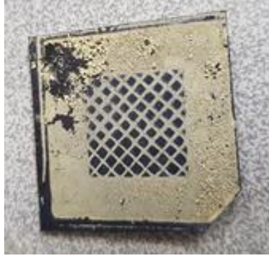
Şekil 4.22. AFN 549 ile çürüten Dyo SF boyası ile maskelenmiş silikon dilim
