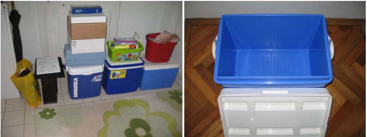
Şekil 39. Su örneklerinin muhafazasında ve naklinde kullanılan numune kapları
