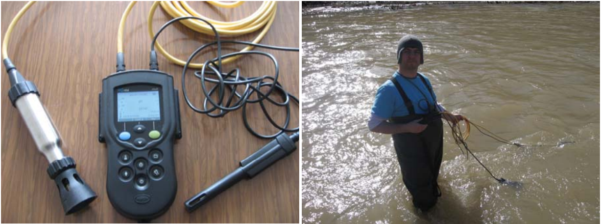
Şekil 37. Akarsuda \text{CO}_2 , t, pH ve Eİ ölçümlerinde kullanılan HQ 40 d
