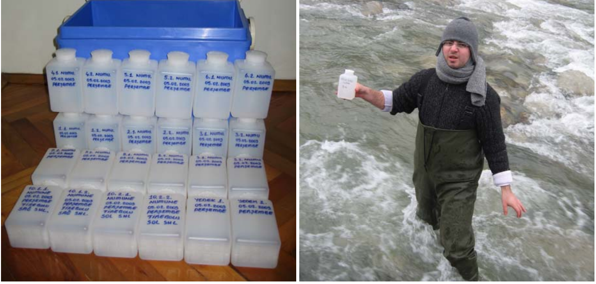
Şekil 38. Yüzeysel ham su örneklerinin alındığı 500 ml hacimli PET numune kapları
