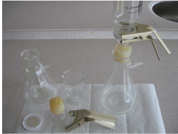
Şekil 41. Filtre kağıtlarının kullanıldığı vakumlu filtrasyon seti
