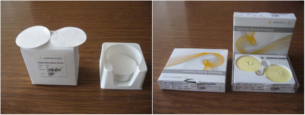
Şekil 40. Filtrasyon işleminde kullanılan selüloz nitrat ve cam yünü filtreler
