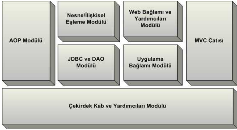
Şekil 3.3: Spring çatısını oluşturan modüller (Walls and Breidenbach, 2005)
