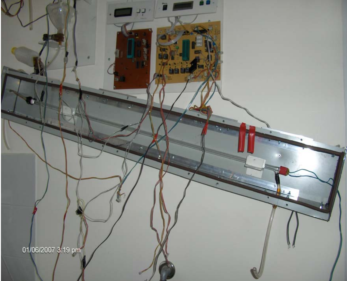
Şekil 4.2. Geliştirilen uzun hücre yollu cam spektrofotometre.
