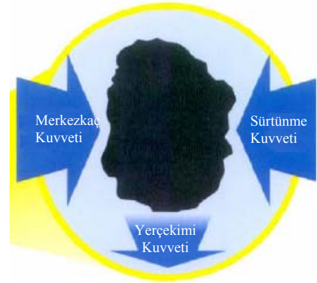
Şekil 3.29. O-Sepa sınıflandırıcılarda etkin olan kuvvetler
