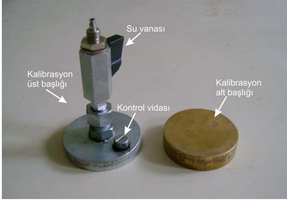
Şekil 5.10. Deneylerde kalibrasyon için kullanılan alt ve üst başlıklar.
