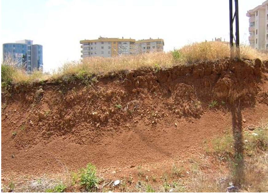
řekil 3.2. rnekleme alanındaki Ankara kilinde aılmıř bir yol yarmasından grnm (Yzncyıl Mahallesi).
