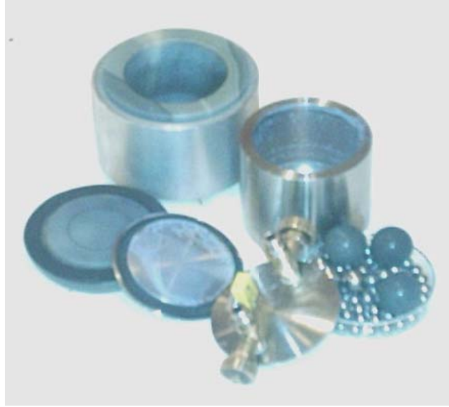
Şekil 3.7. Mekanik öğütmede kullanılan havan ve bilyeler
