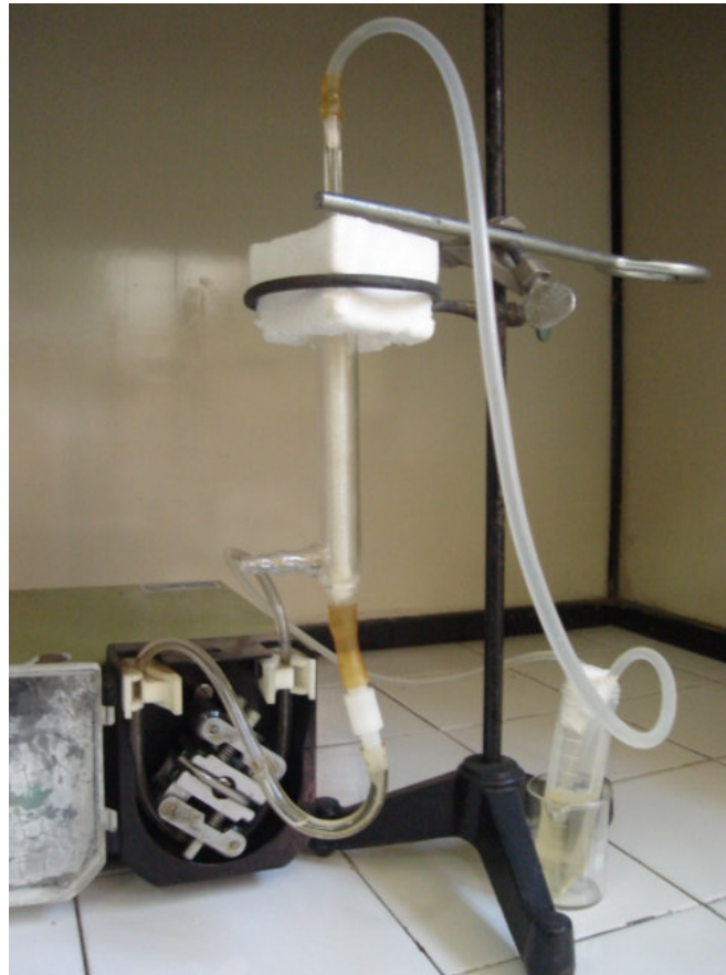
Şekil 3.2. Tribütirin transesterleşme/interesterleşme tepkimesinde kullanılan akışkan yatak sistemi
