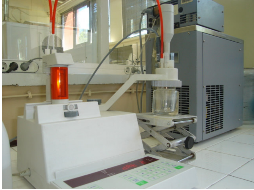
Şekil 3.1. Tribütirin hidrolizinde kullanılan deney düzeneği
