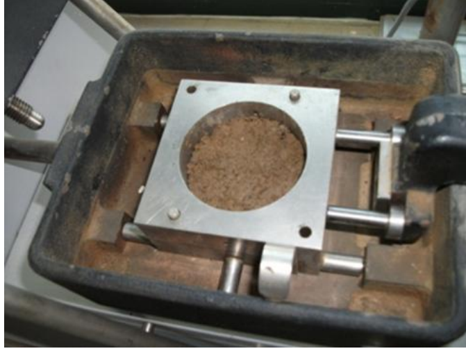
Şekil 2.15. Kesme kutusuna yerleştirilmiş numune
