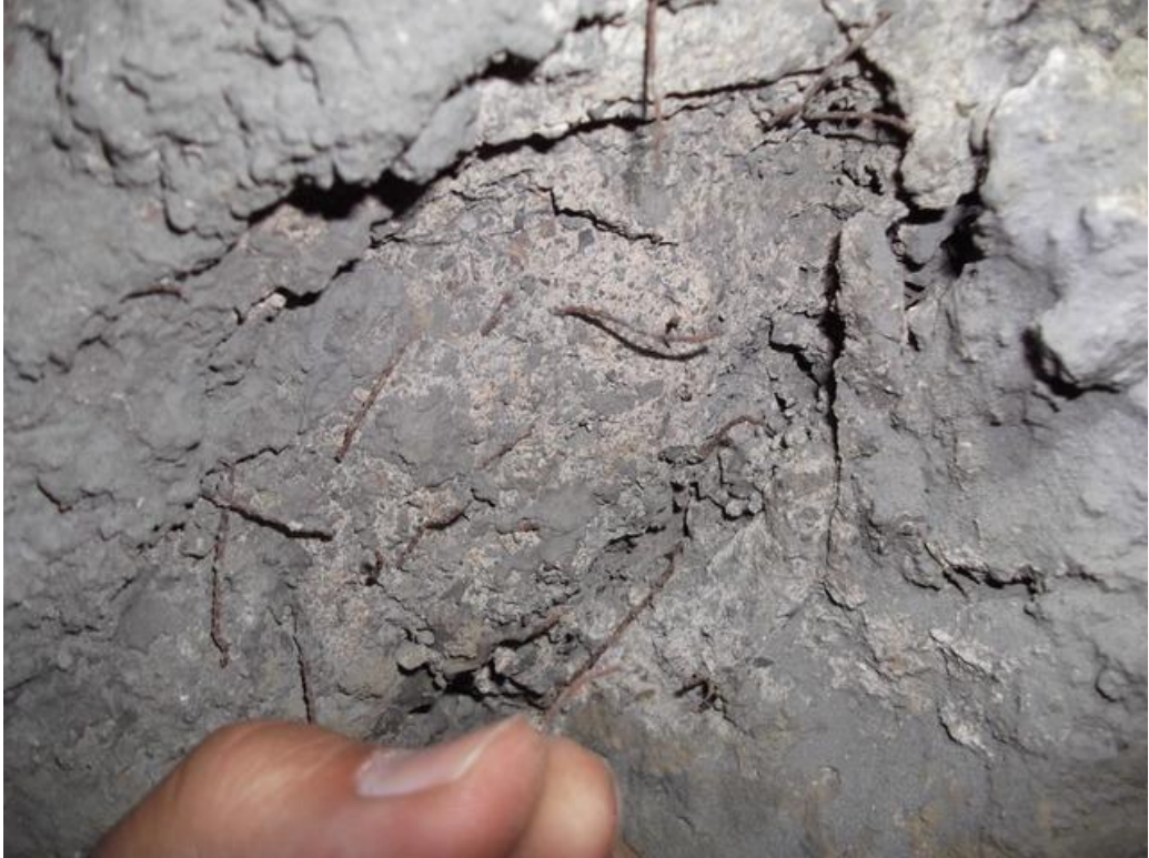
Şekil 1.18. El ile koparılabilen paslanmış çelik fiberler
