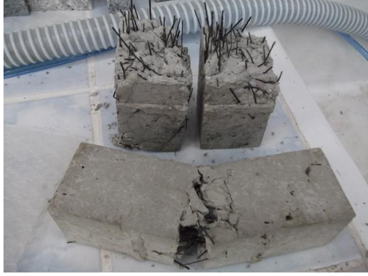
Şekil 2.13. Polimer fiberli, kırılmış eğilme dayanımı numuneleri
