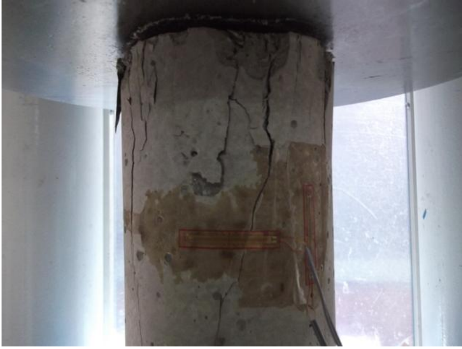
Şekil 2.10. Tek eksenli basınç altındaki deformabilite deneyi numunesi
