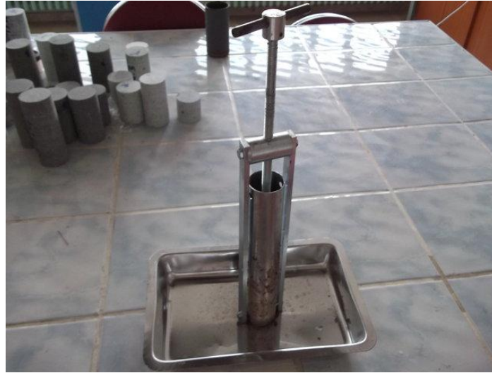
Şekil 2.44. Sıkıştırılmış tek eksenli basma dayanımı numunesi hazırlama
