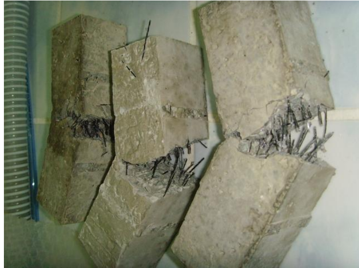
Şekil 2.14. Polimer fiberli, kırılmış eğilme dayanımı numuneleri
