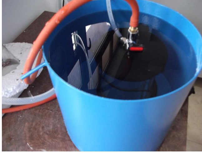
Şekil 2.43. Islama haznesi içindeki numune kalıbı
