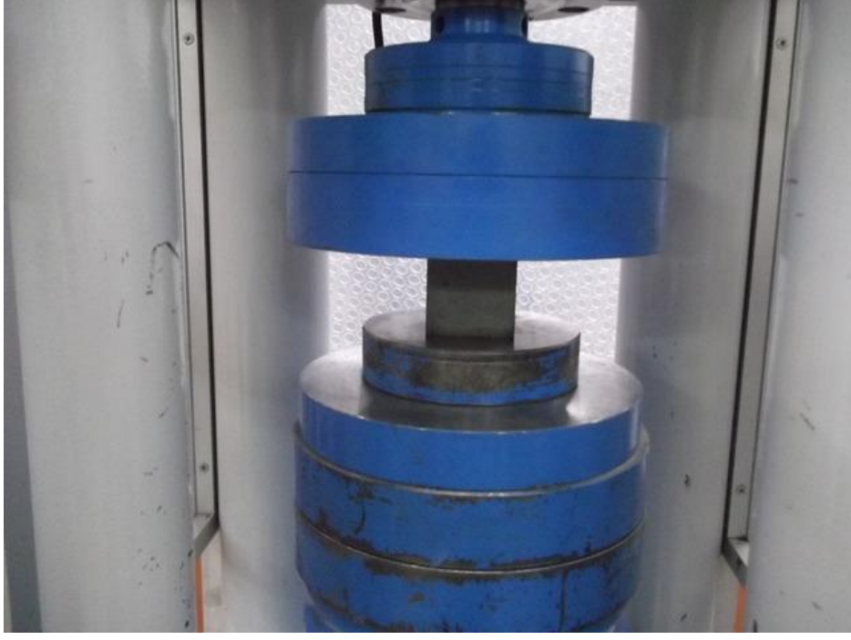
Şekil 2.51. Çimentolu atık malzemesinin tek eksenli basma dayanımı testi
