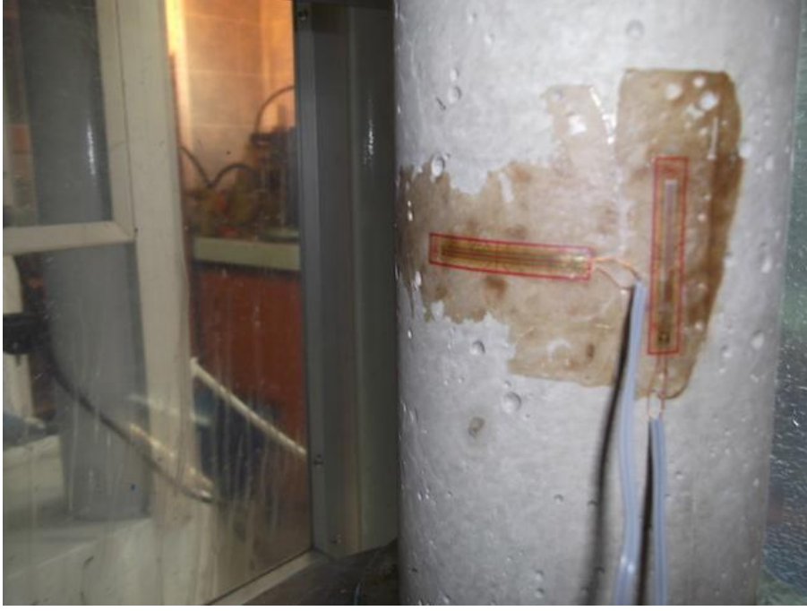
Şekil 2.8. Gerinim ölçer yapıştırılmış numune
