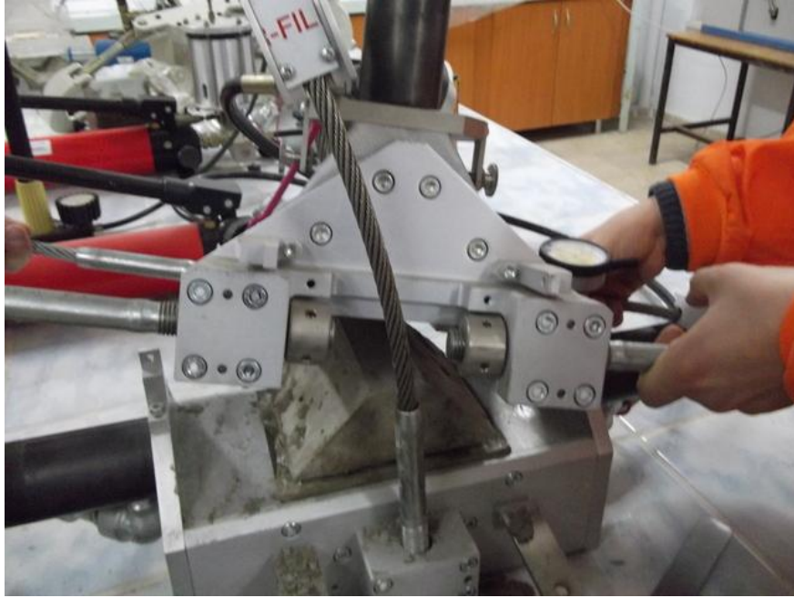
Şekil 2.69. Kalıplanmış numune kesme (makaslama) dayanımı deneyi mekanizmasına yerleştirilirken
