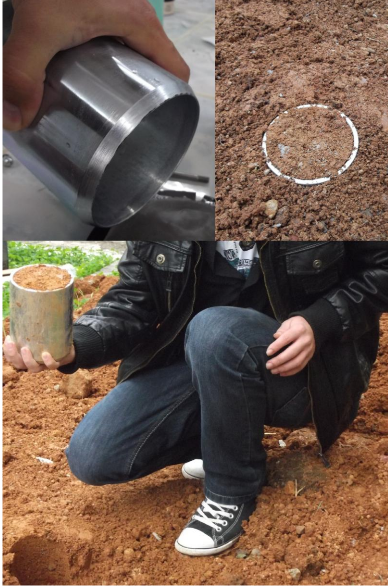
Şekil 2.42. Permabilite numune kalıbı ve numune alma
