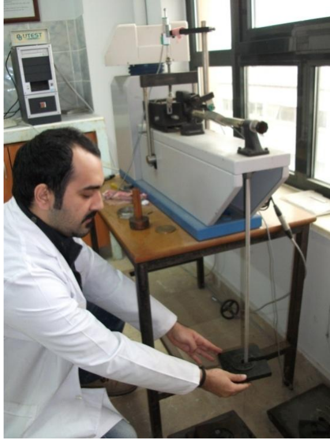
Şekil 2.41. Konsolidasyon testi için düzeneğe ağırlık takılışı
