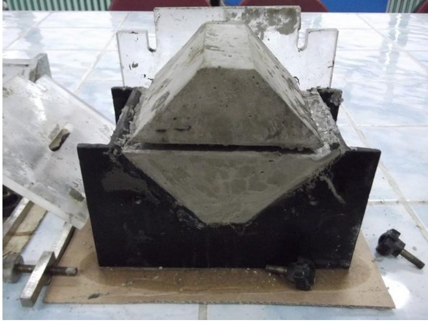
Şekil 2.68. Kalıplanmış doğrudan kesme testi numunesi
