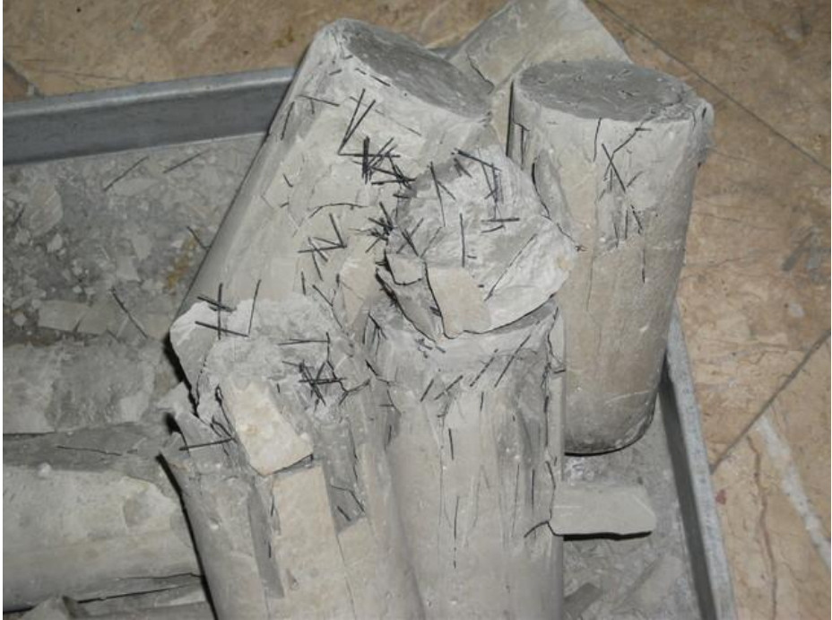
Şekil 2.7. Kırılmış polimerli beton numuneleri
