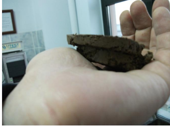
Şekil 2.16. Kesme kutusunda kırılmış numune
