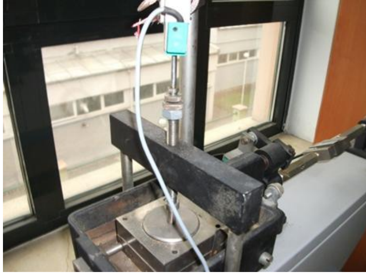
Şekil 2.33. Numunenin oturma miktarının LVDT ile ölçülmesi
