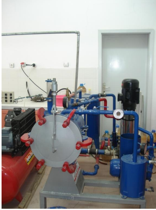
Şekil 4. Laboratuvar tipi silindirik emprenye kazanı
