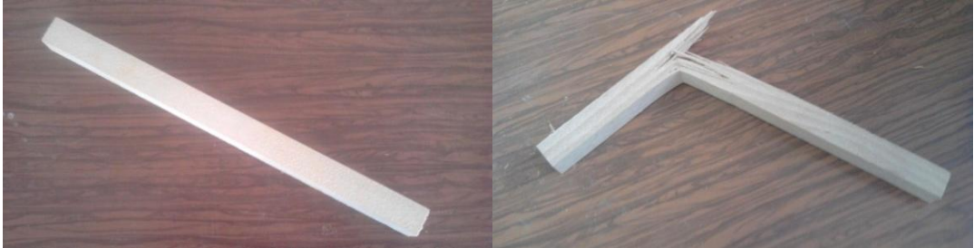
Şekil 7. Deneyde kullanılan test örneğinin deney öncesi ve deney sonrasındaki durumu
