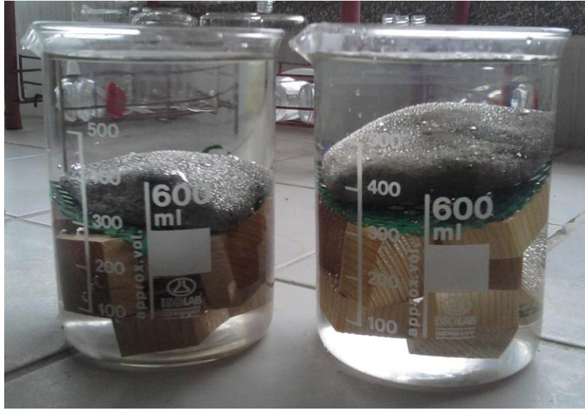
Şekil 5. Su alma oranı ve su itici etkinlik değerlerinin belirlenmesi
