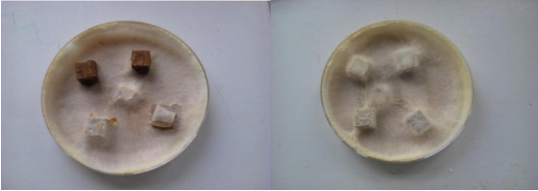
Şekil 8. Mini - blok mantar çürüklük testinin uygulanışı
