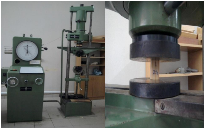
Şekil 6. Liflere paralel basınç deneyinin gerçekleştirilmesi
