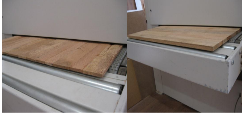
Şekil 23. Preslenmiş masif panel taslaklarının kalibrasyonu
