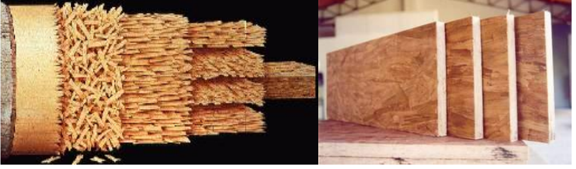
Şekil 12. OSL üretiminde kullanılan yongaların elde edilmesi ve OSL örneği
