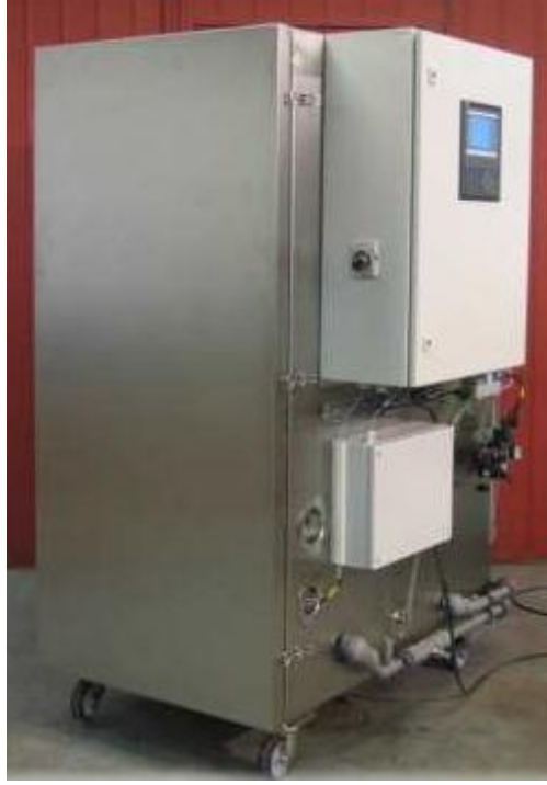
Şekil 28. 1m 3 'lük VOC test kabini
