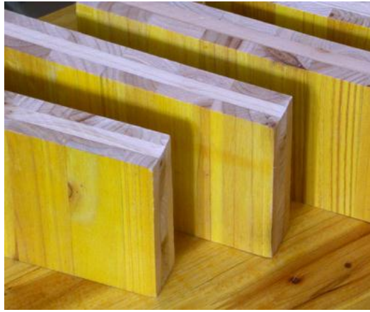
Şekil 3. 3 Tabakalı masif ahşap panel örneđi
