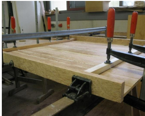
Şekil 22. Lamellerden masif panel hazırlanması
