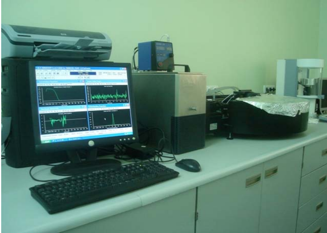
Şekil 4.3 C \lambda_0=632.8 \text{ nm} 'de çalışan 22 mV Helyum-Lazeri ve ALV/LSE-5003 Multi-8-Serisi kolektör donanımlı bir Malvern ALV/CGS-3 spektrometre cihazı
