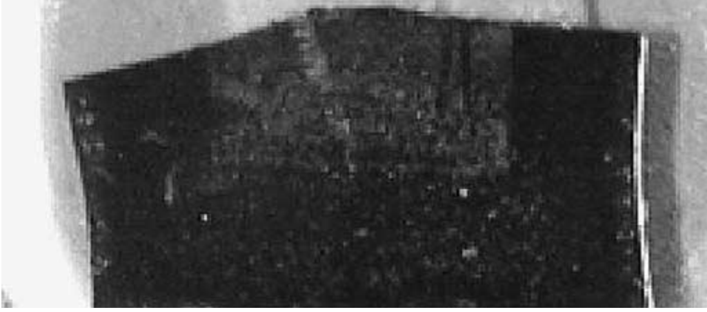
Şekil 1.20. TSMG yöntemiyle üretilen standart YBCO örneğinin a/c düzlemlerine paralel bir kesitinin optik içyapı resmi. En yüksek nokta çekirdeğin konumu (Diko, 2004).
