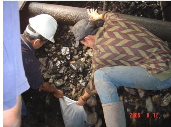
Şekil 5.2. Akışların kesilmesiyle numune alınması
