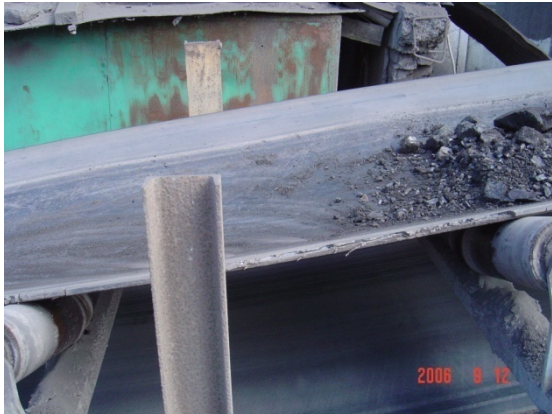
Şekil 5.1. Konveyörün sıyırılmasıyla numune alınması
