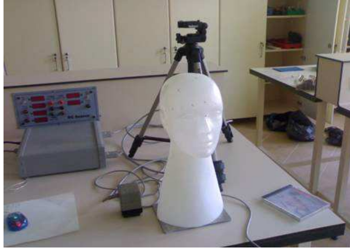
Şekil 5.12. Üç boyutlu koordinat belirleyici kalem ve fantom
