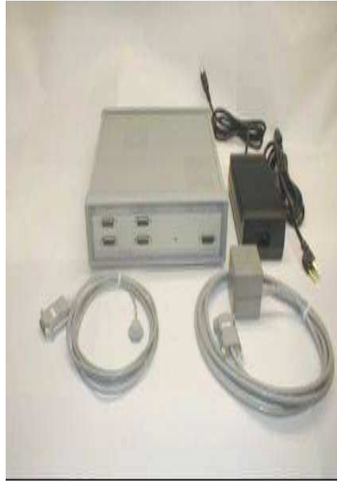
Şekil 5.11. Fastrak üç boyutlu koordinat belirleyici kalem sistemi
