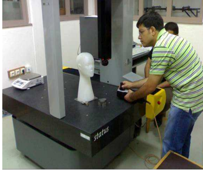
Şekil 5.9. CMM tezgahı ve ölçüm düzeneği.
