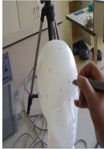
Şekil 5.13. Üç boyutlu koordinat belirleyici kalem ile elektrot konumlarının ölçülmesi
