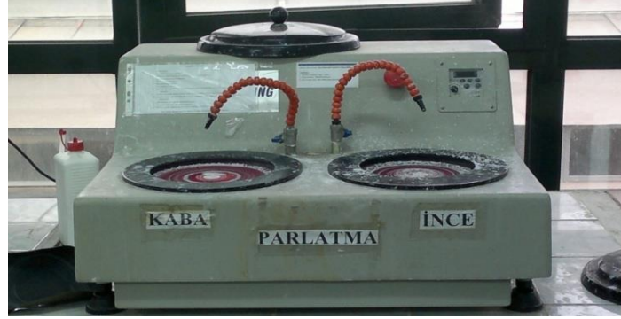
Şekil 2.8. Yarı otomatik parlatma makinası
