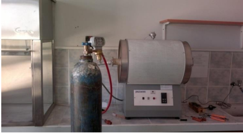
Şekil 2.4. Sinterleme işleminin gerçekleştirildiği fırın ve argon tüpünün genel görünümü
