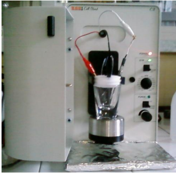
Şekil 3.3. Elektrokimyasal çalışma istasyonuna bağlı üçlü elektrot sistemi.
