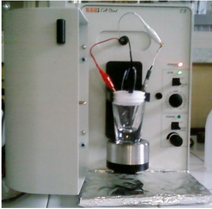
Şekil 4.28. Hazırlanan enzim elektrodunun performansının bakıldığı yarı hücre (üçlü elektrot sistemi)
