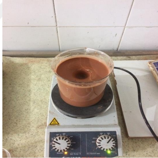
Şekil 3.7. Kil + %1 Nano TiO 2 Kompozit malzemenin magnetik karıştırıcıda karıştırılması
