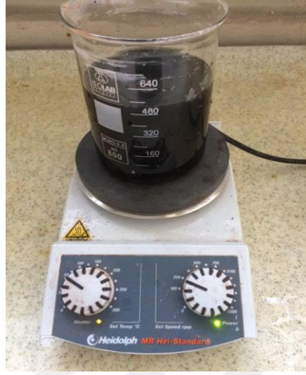
Şekil 3.5. Kil + %1 nano CuO kompozit malzemenin hazırlanışı
