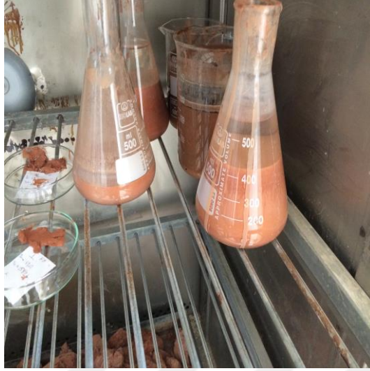
Şekil 3.8. Kil + %1 Nano TiO 2 Kompozit malzemenin etüvde kurutulması
