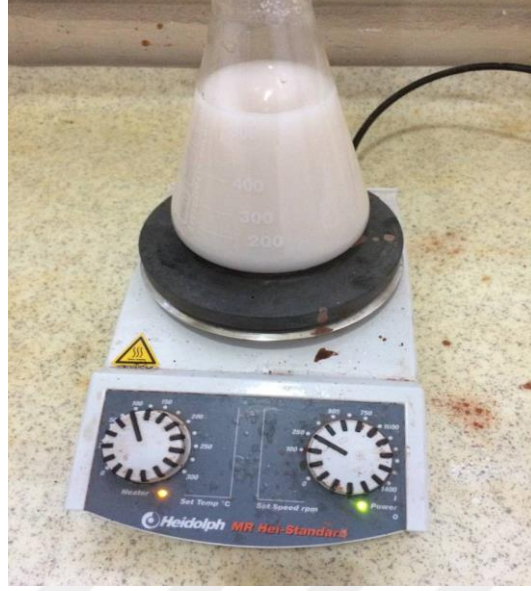
Şekil 3.6. Kil + %1 Nano TiO 2 Kompozit malzemenin hazırlanışı
