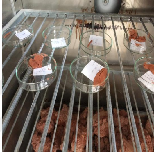
Şekil 3.10. Kıvam limit deneyine ait numunelerin etüvde kurutma aşaması
