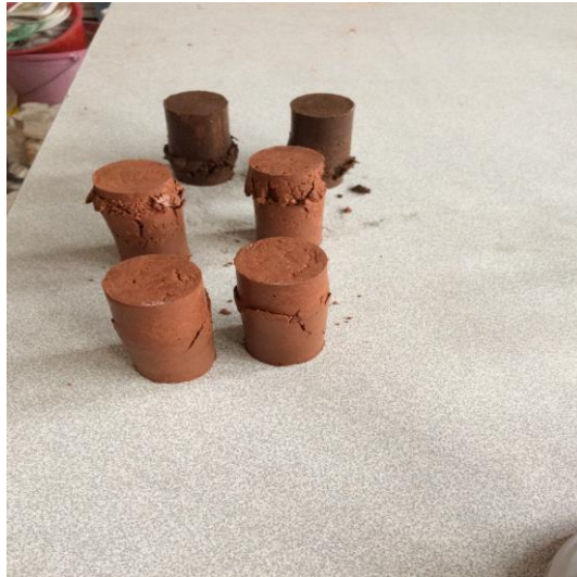
Şekil 3.15. Kırılmış bazı numunelere ait görüntüler (Serbest Basınç Deneyi)
