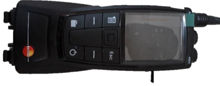
Şekil 3.15. Testo 480 marka anemometre
