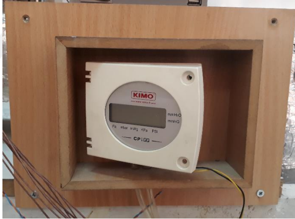
Şekil 3.16. KIMO CP100 marka diferansiyel basınç transduseri
