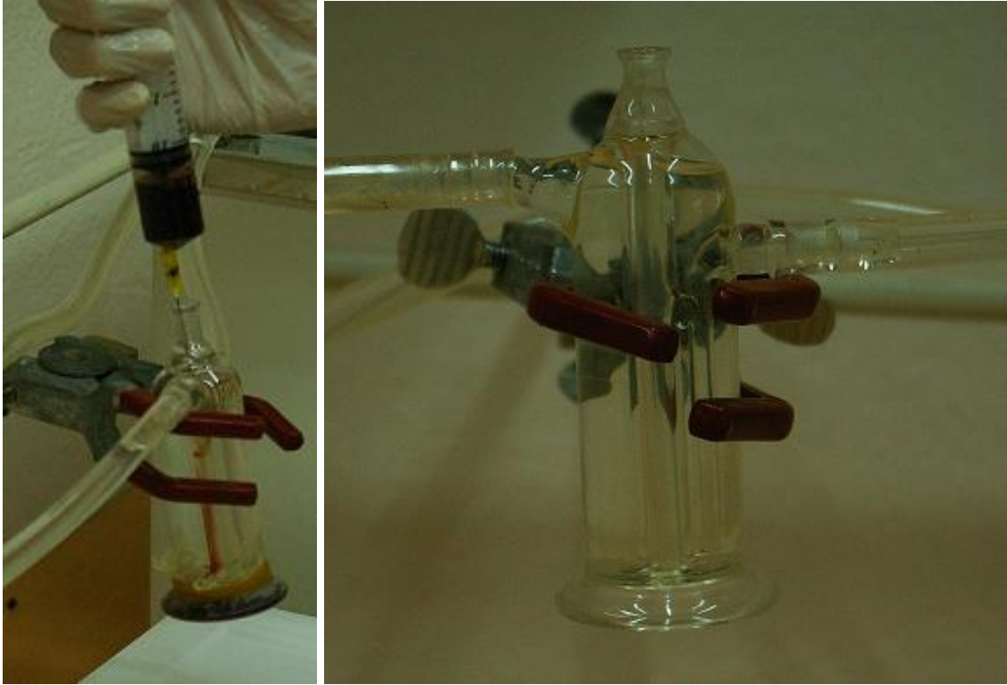
Şekil 3.2. Kan sirkülasyon ve emdirme aparatı.
