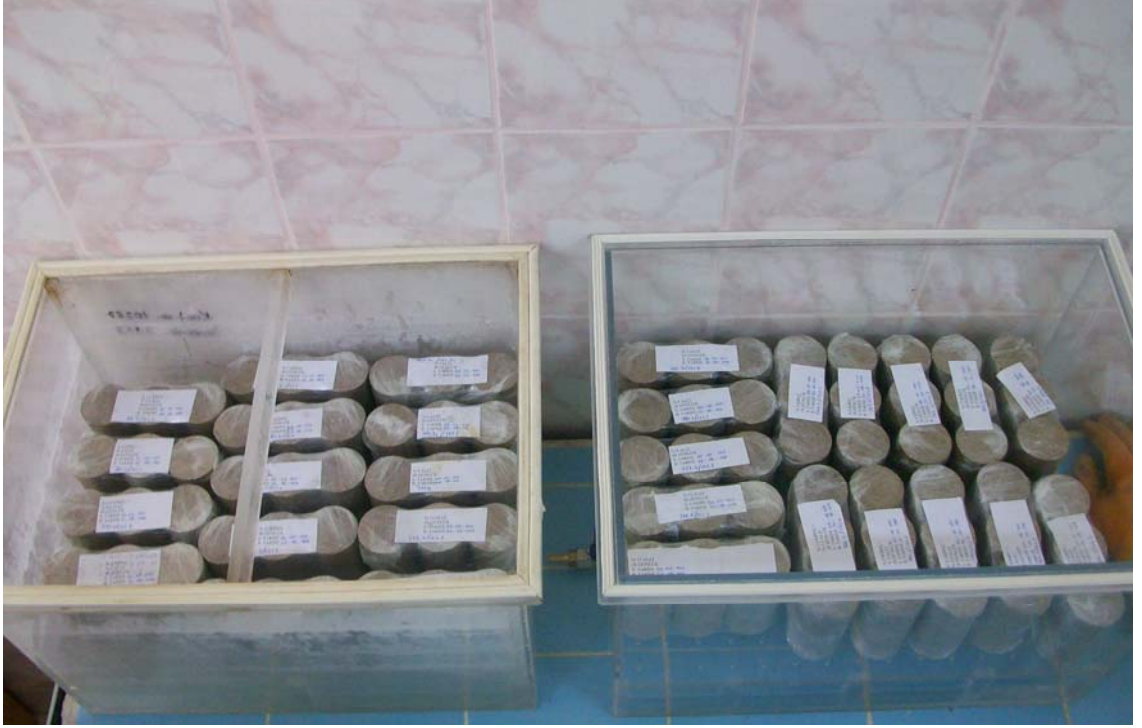
Şekil 1.2 Farklı oranlardaki kireç, jips ve kireç-jips karışımlarında tek eksenli basınç dayanımı için hazırlanan kil örnekleri
