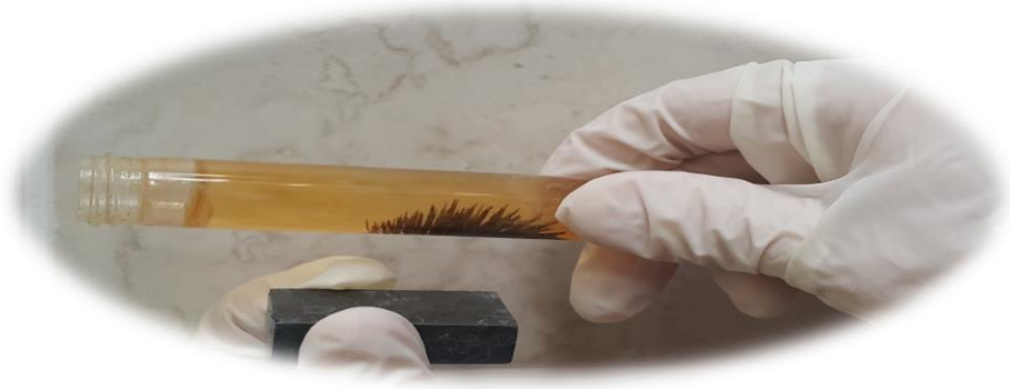
Şekil 1.5. Çözelti ortamındaki Fe_3O_4 nanopartiküllerin üzerine manyetik alanın etkisi (Altundaş vd 2017).
